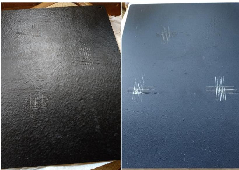
Slika 42: Na svakom od 6 uzoraka test je rađen na tri različita mesta
