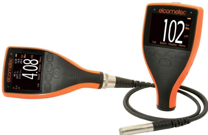
Slika 19: "Elcometer 456" uređaj za mjerenje debljine suhog filma premaza [24]
