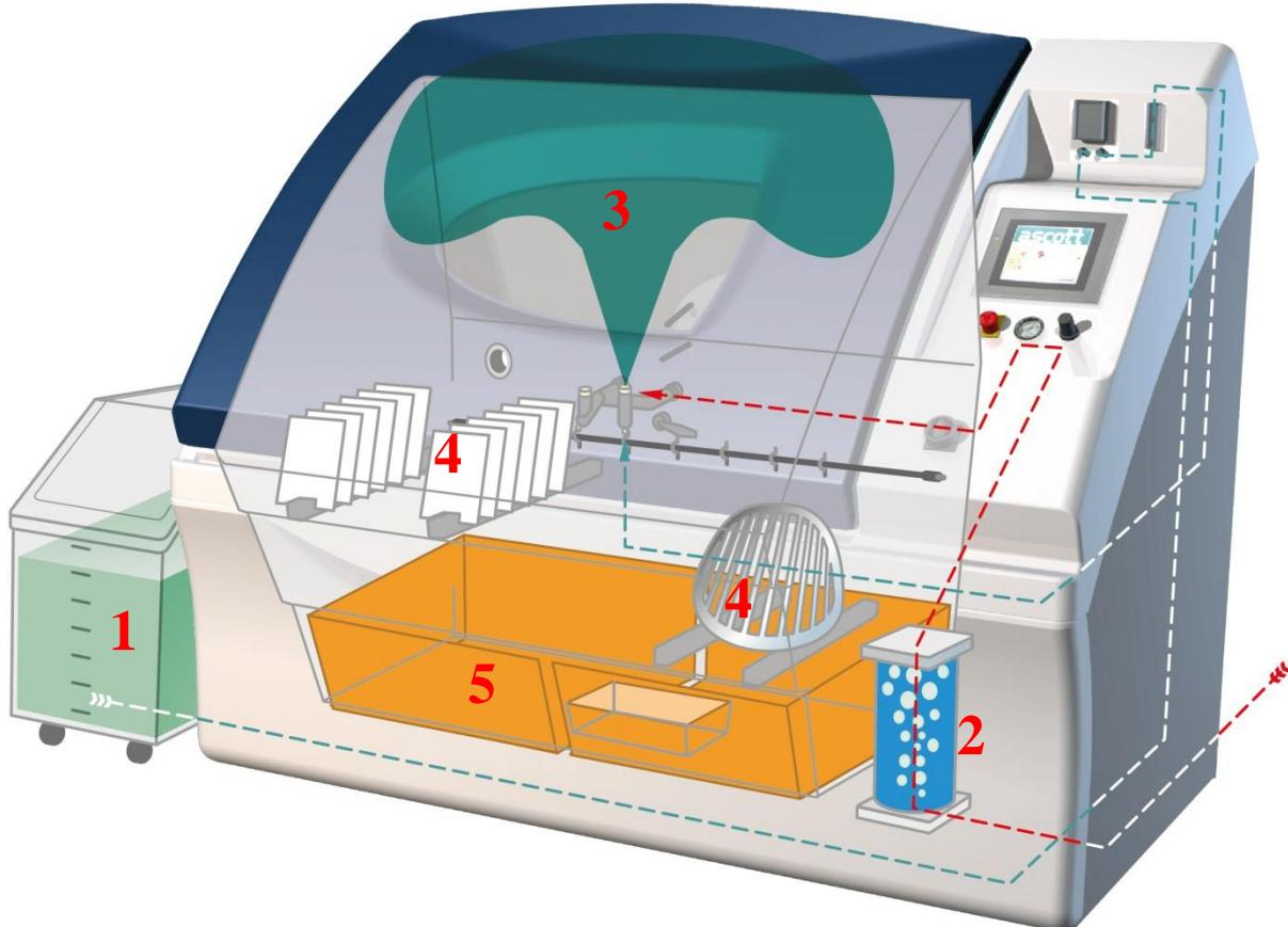
Slika 22: Shematski prikaz slane komore: 1 – spremnik otopine NaCl-a, 2 – uređaj za zasićivanje zraka (osigurava visoku vlažnost), 3 – maglica otopine NaCl-a, 4 – testni uzorci, 5 – grijaci (osiguravaju odgovarajuću temperaturu [27]
