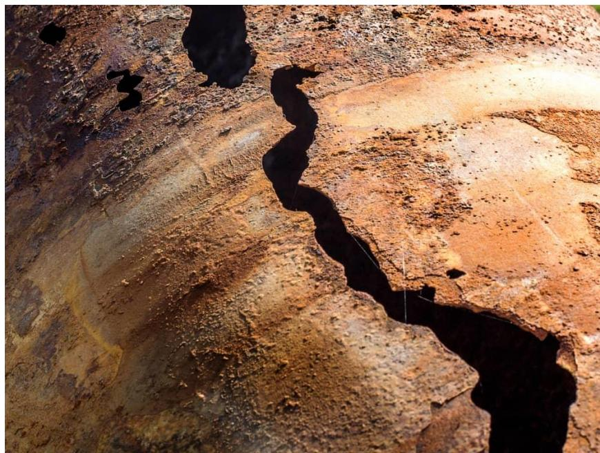
*Slika 9: Oštećenje na cijevi zbog erozijske korozije [14]*
