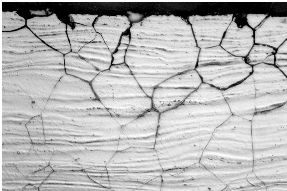
Slika 6: Pojava interkristalne korozije na granicama zrna [11]
