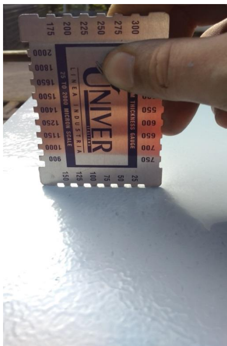
Slika 36: Postupak mjerenja debljine mokrog fila temeljnog premaza
