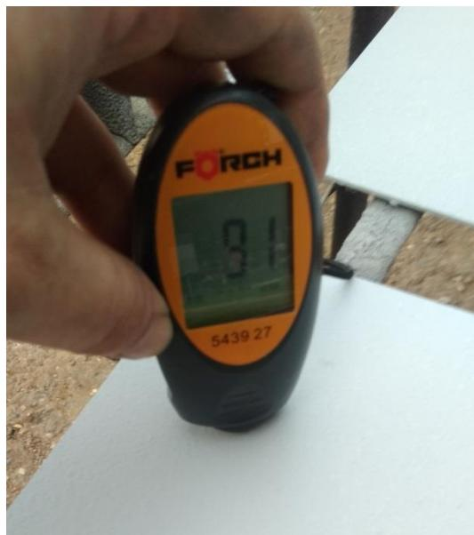
*Slika 37: Mjerenje debljine suhog sloja temeljnog premaza*
