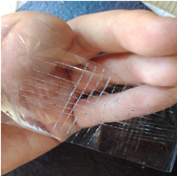
Slika 41: Na ljepljivoj vrpici ostaju tragovi premaza koji su se oljuštili s rubova ureza
