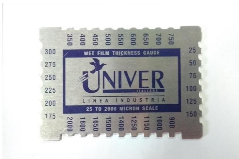
Slika 31: Češalj za mjerjenje debljine mokrog filma premaza korišten za mjerjenje
