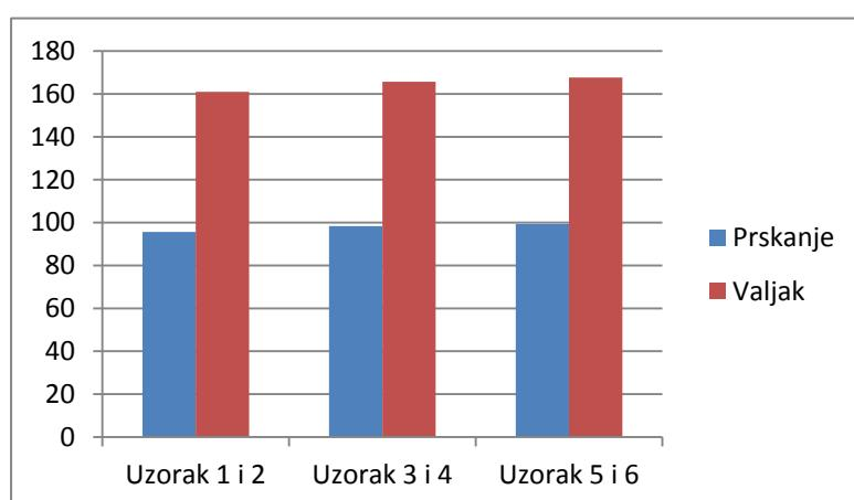
Graf 4: Usporedba izmjerenih vrijednosti debljina suhog filma nakon nanošenja završnog premaza izražene u μm
