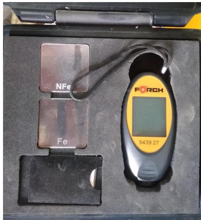
Slika 32: Förch uređaj za mjerjenje debljine suhog filma premaza
