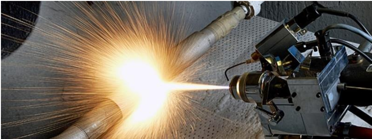
Slika 13: Postupak nanošenja metalne prevlake vrućim prskanjem [19]
