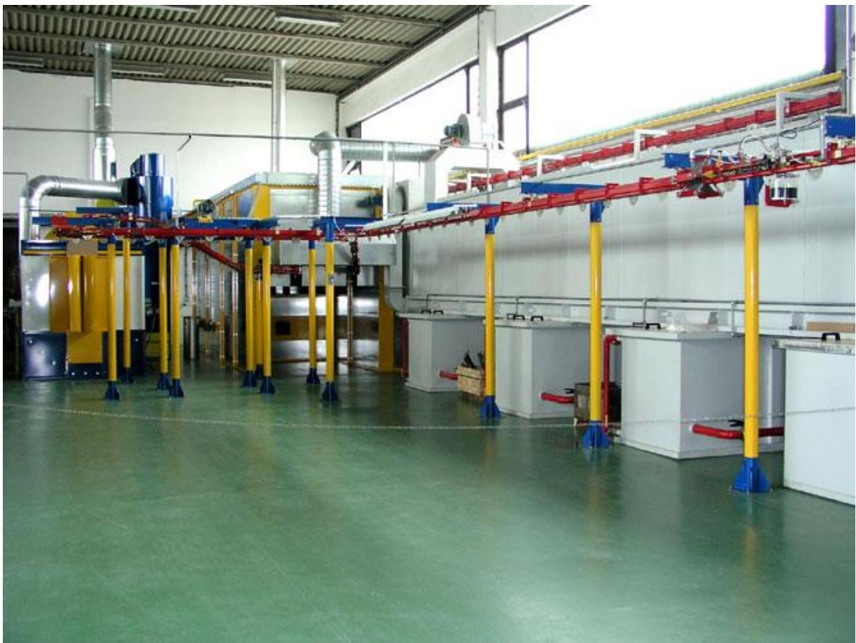
*Slika 14: Pogon za plastifikaciju (elektrostatsko nanošenje prevlake u praškastom obliku) u tvrtci Dekor tvornica rasvjete d.o.o., Zabok – na slici je vidljiva komora za nanošenje praha, peć te lančani transporter za koji se vješaju obradci*
