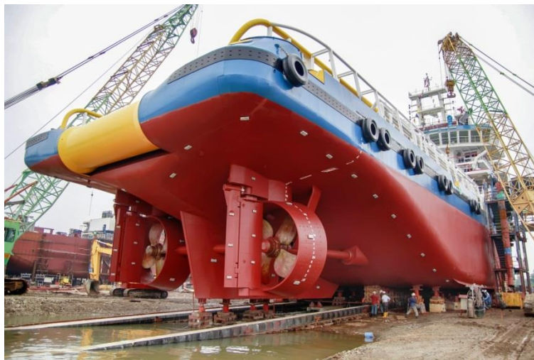
Slika 11: Katodna zaštita na trupu broda - na trup broda su pričvršćene žrtvene anode [18]
