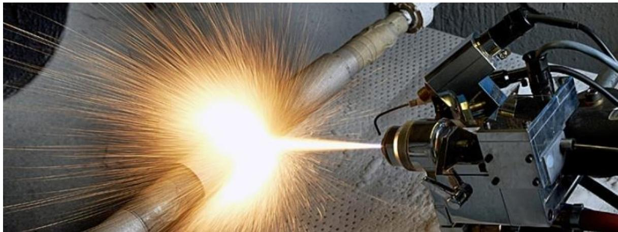
Slika 13: Postupak nanošenja metalne prevlake vrućim prskanjem [19]
