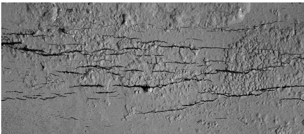
Slika 10: Pukotine nastale zbog napetosne korozije na vanjskoj stjenci visokotlačnog plinovoda [15]
