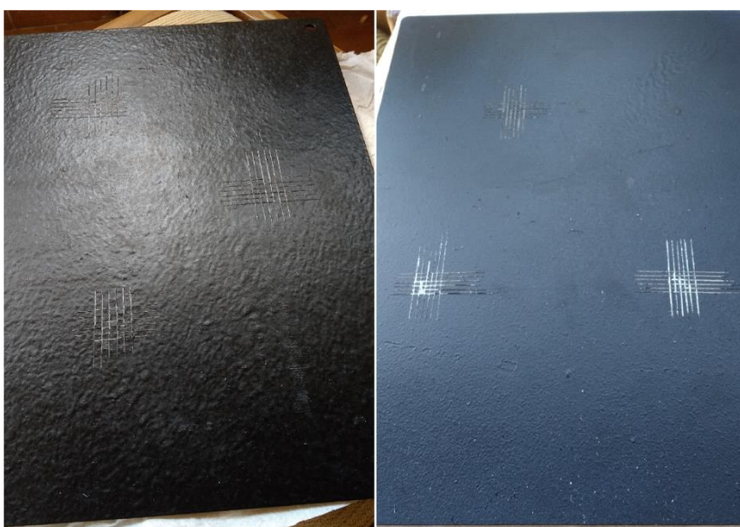
Slika 42: Na svakom od 6 uzoraka test je rađen na tri različita mjesta
