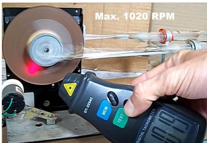
Slika 2.48 Broj okretaja \alpha -stirlinga bez regeneratora
