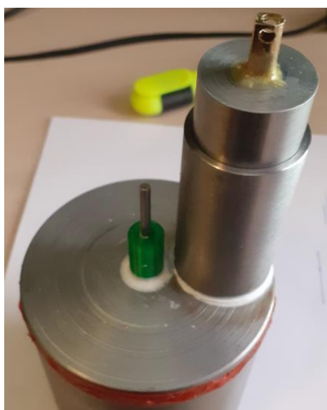
Slika 3.15 Spoj radnog klipa i cilindra
