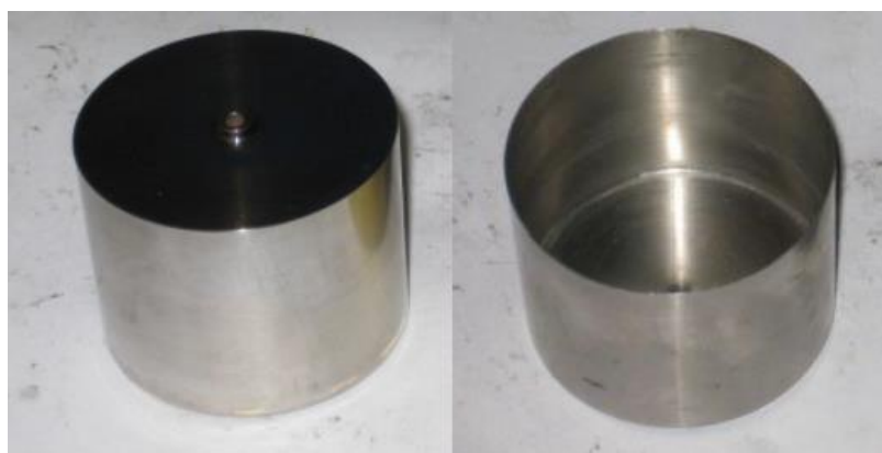
Slika 2.49 Primjer potiskivača od nehrđajućeg čelika -34grama
