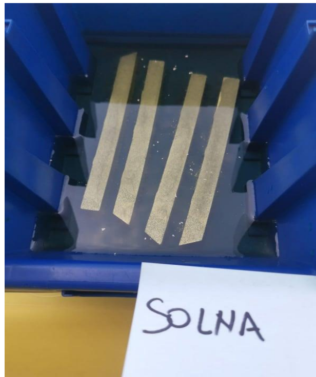
Slika 9.6. Uzorci uronjeni u solnu kiselinu 24,5%
