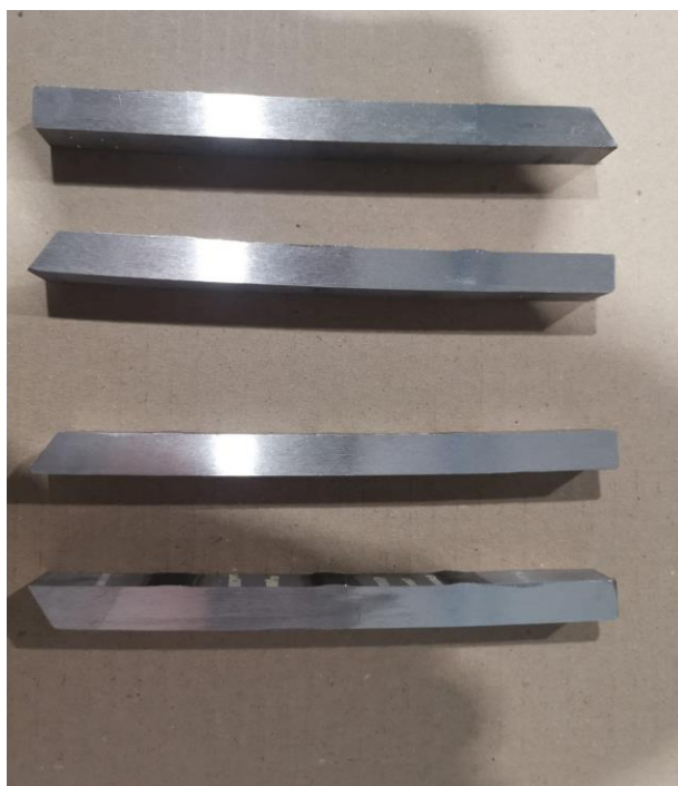
Slika 9.5. Skraćeni i pobrušeni uzorci
