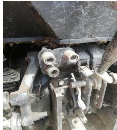
Slika 7.4 Brze spojnice na traktoru
