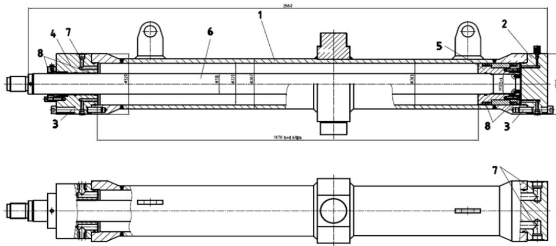
Slika 8.1 Presjek dvoradnog cilindra
