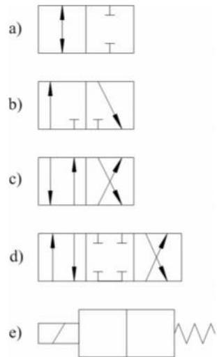
*Slika 8.5 Razvodnici: a) 2/2, b) 3/2, c) 4/2, d) 4/3, e) sa dva razvodna položaja, upravljan elektromagnetom i oprugom*
