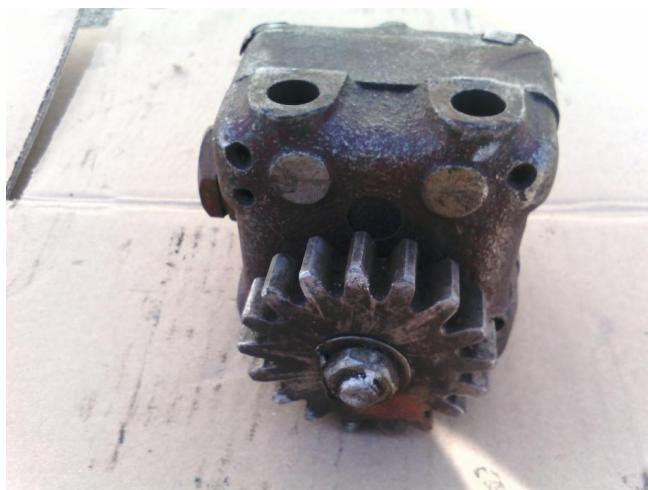
*Slika 7.2 Hidraulička pumpa*
