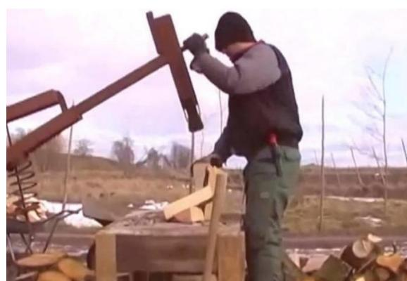
*Slika 4.3 Ručni cjepač drva*
