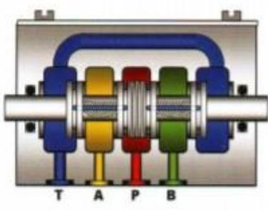
*Slika 8.6 Hidraulični razvodnik s tandem centrom*
