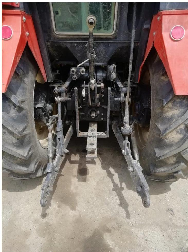
*Slika 7.8 Stražnji prikaz traktora za prikopčavanje*
