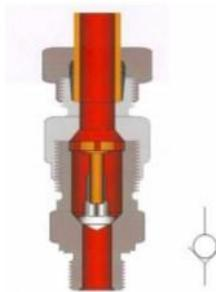
Slika 8.11 Presjek nepovratnog ventila bez opruge
