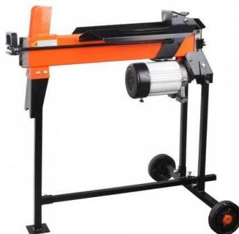
Slika 4.2 Električni cjepač drva
