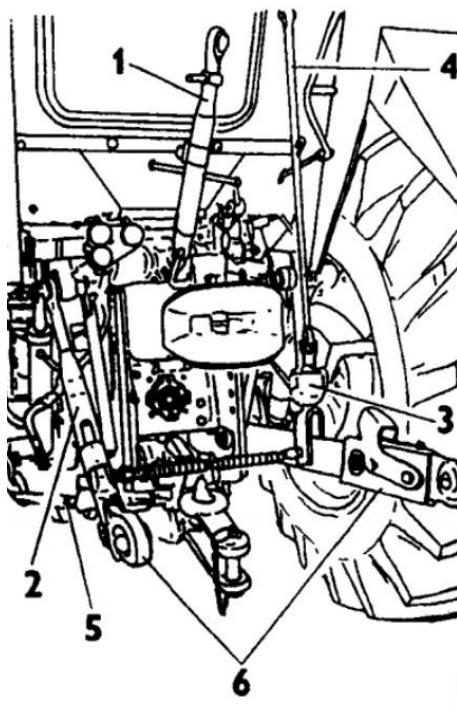
Slika 7.7 Dijelovi za prikopčavanje strojeva
