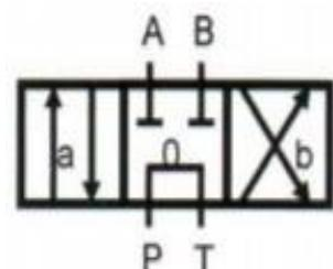
*Slika 8.7 Simbol hidrauličnog razvodnika s tandem centrom*
