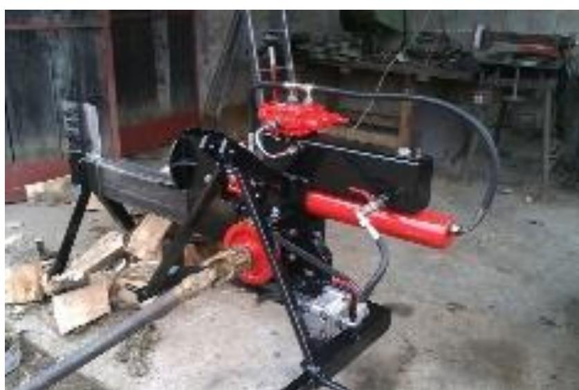
*Slika 4.1 Hidraulični cjepač drva*
