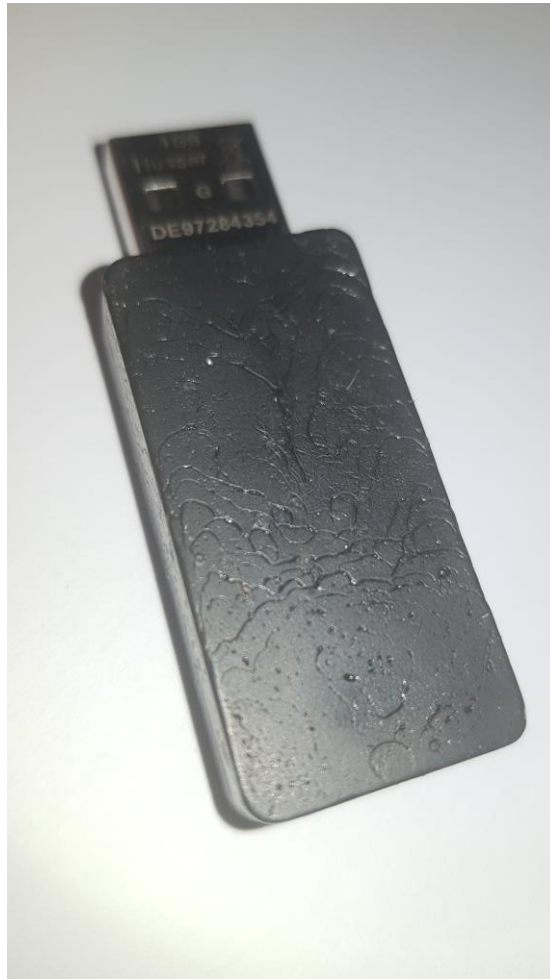
Slika 55 Pojava nakon prvog lijevanja
