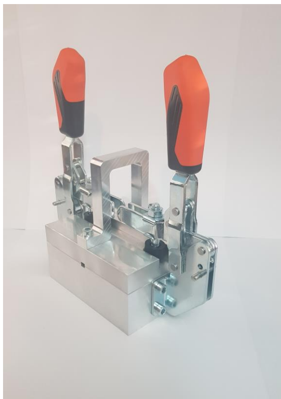
Slika 49. Sklop kalupa – zatvoreni
