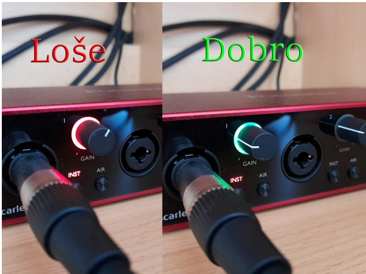
Slika 5.1.2. Prikaz signala koji clippa
