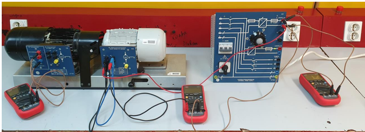
Slika 7.4. Spojeni elementi prema shemi pokusa praznog hoda
