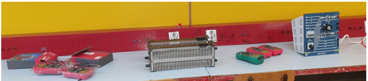
Slika 7.3. Oprema pokusa praznog hoda
