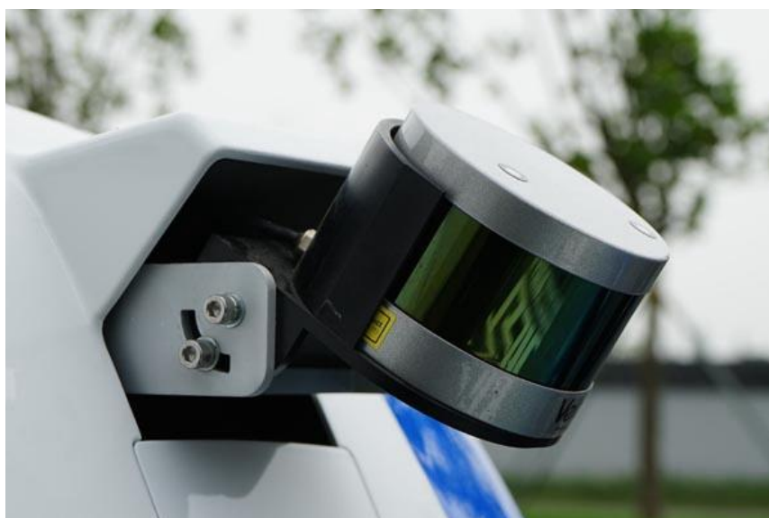
Slika 3.4 LIDAR s višestrukim zrakama svjetlosti [9]
