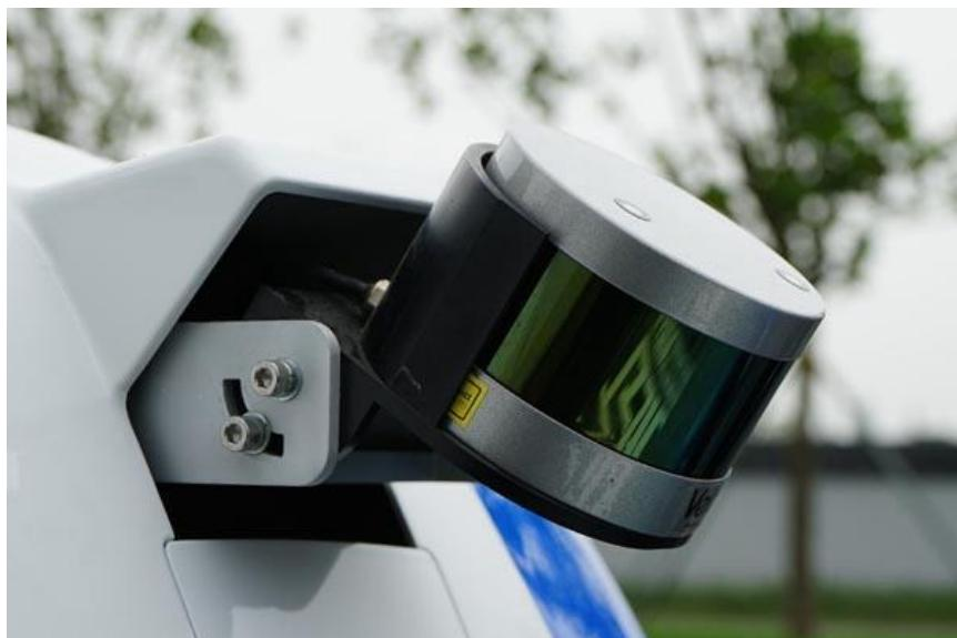
Slika 3.4 LIDAR s višestrukim zrakama svjetlosti [9]
