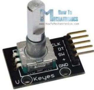
Slika 3.2 Rotacijski enkoder [20]
