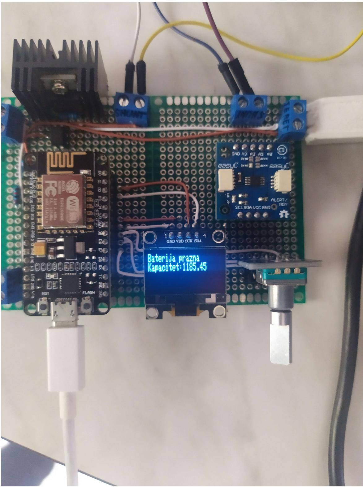
Slika 6.9 Kraj ispitivanja i ispis kapaciteta na OLED-u
