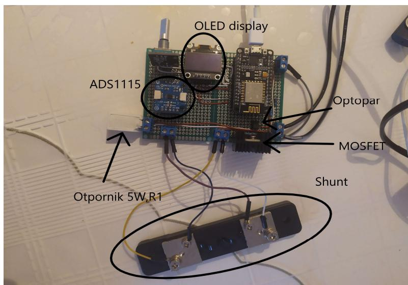
Slika 4.11 Sklop s označenim komponentama
