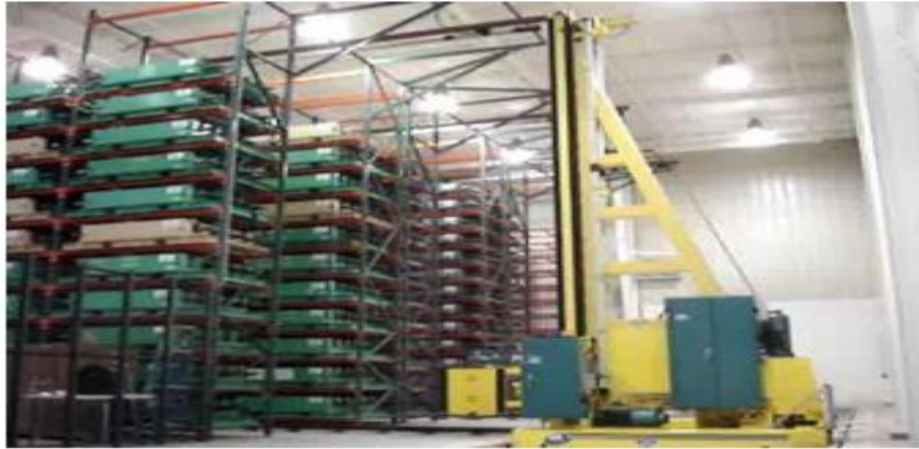
Slika 19. Aisle transfer cart
