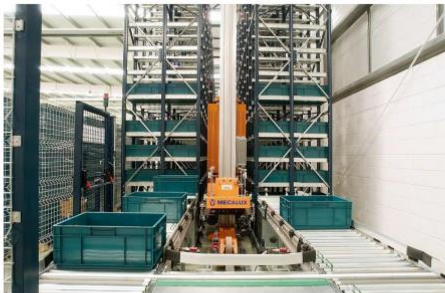
Slika 10. Mini load AS/RS sustav
