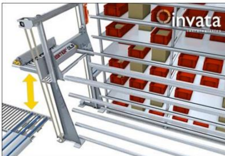
Slika 31. One level sustav s regalnim vozilima
