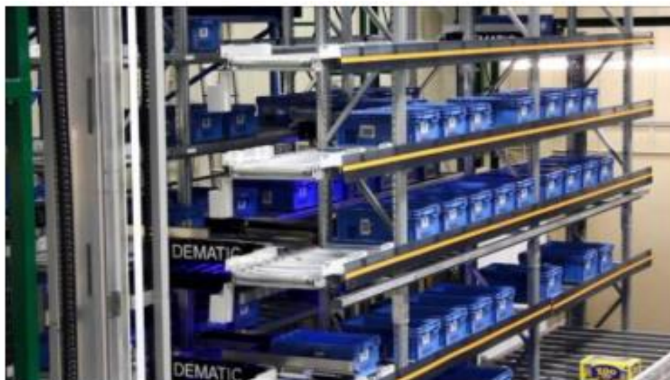
Slika 32. Multishuttle 2 sustav s regalnim vozilima
