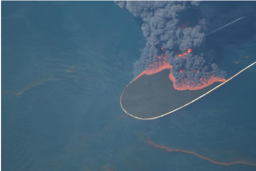
Slika 4-11: Kontrolirano spaljivanje nafte [32]
