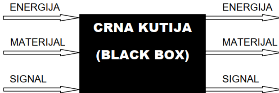
Slika 5. Općenita funkcija sklopa
