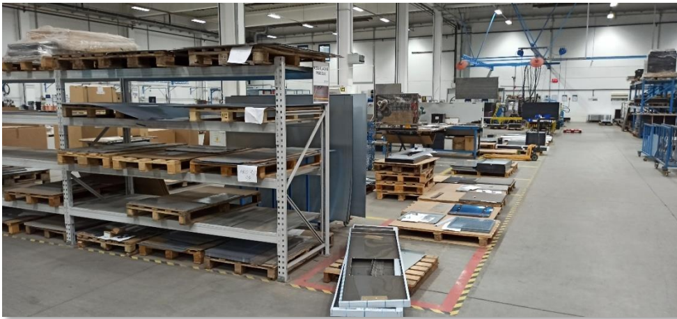
Slika 51 - Dio pogona označen horizontalnom signalizacijom – trakama
