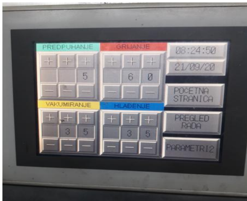
Slika 8. Vrijeme trajanja pojedinih dijelova postupka termoformiranja
