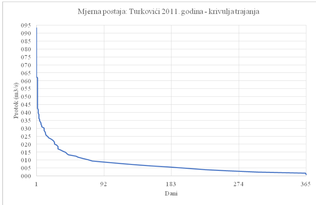
Prilog 11.4.3. Grafički prikaz krivulje trajanja protoka postaje Turkovići za 2011.god.
