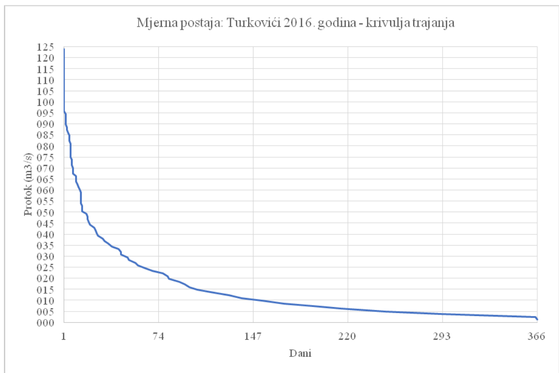
Prilog 11.4.8. Grafički prikaz krivulje trajanja protoka postaje Turkovići za 2016 god.
