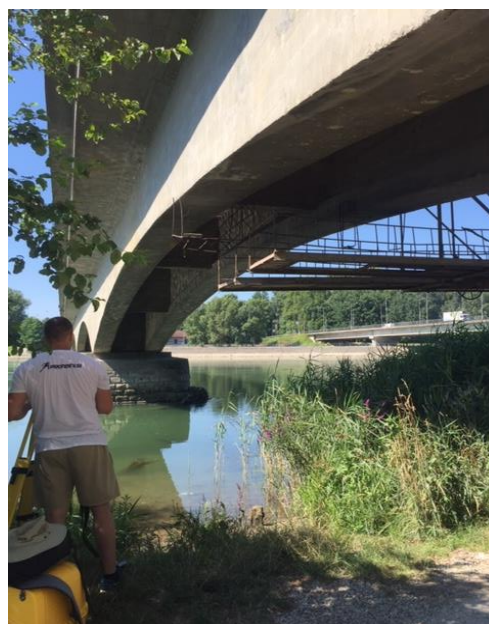
Slika 32. Skeniranje željezničkog mosta
