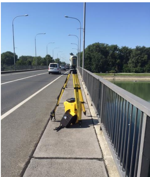
Slika 31. Skeniranje cestovnog mosta
