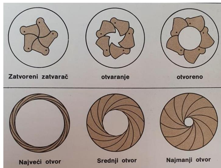
Slika 2.27: Skica zatvarača i otvora u analognim fotoaparatima
