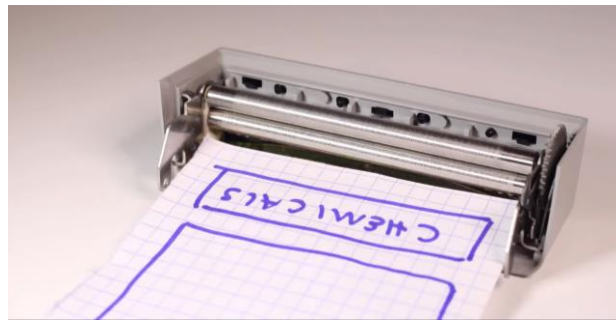
Slika 2.31: Prikaz mehanizma unutar polaroid kamere
