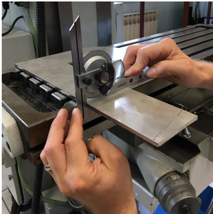
Slika 5.26 Postupak mjerenja kutnosti
