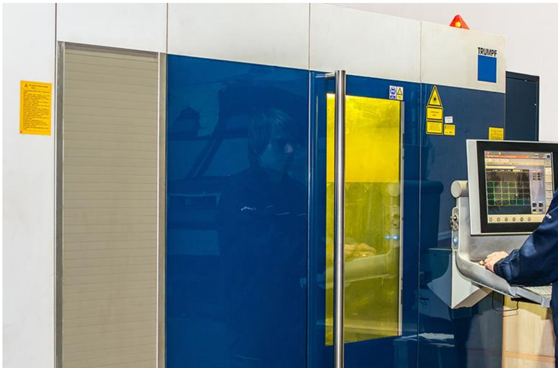
Slika 5.8 Trumpf fiber laser i upravljačka jedinica, [23]
