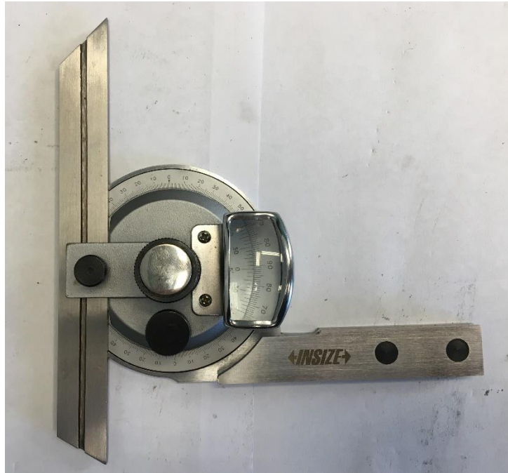
Slika 5.25 Ručni kutomjer korišten za mjerenje
