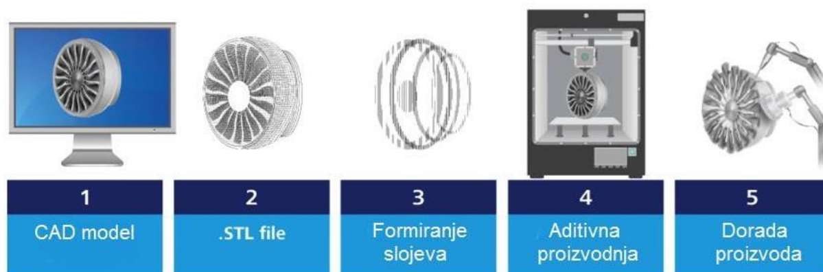
Slika 3.1 Proces aditivne proizvodnje [22]
