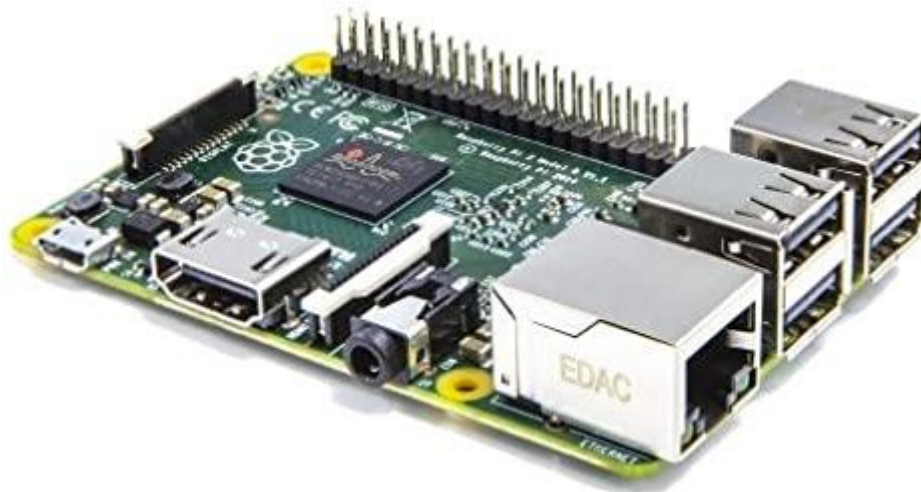
Slika 2.4 - Prikaz Raspberry Pi 2 model B
