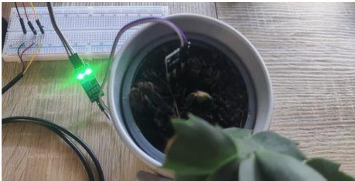
*Slika 3.7 - Kalibriranje senzora vlage*
