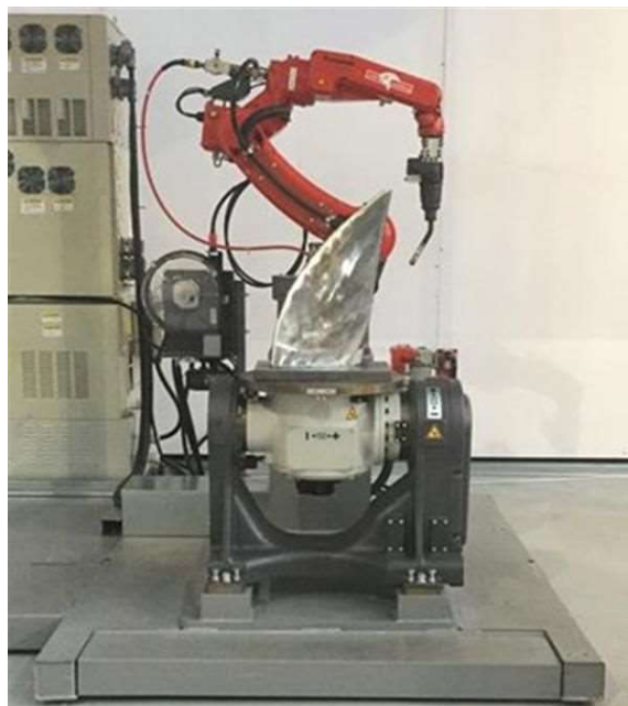
Slika 4.2 Robotska ruka za 3D ispis metala [24]
