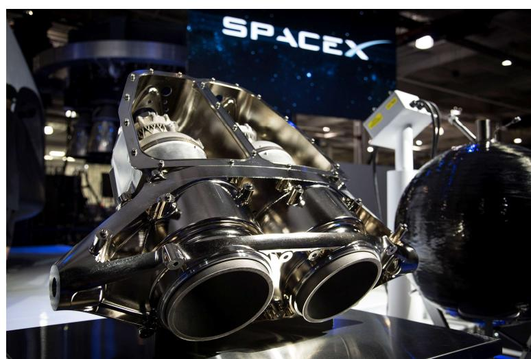
**Slika 4.3** Raketni motor tvrtke SpaceX proizведен 3D ispisom [26]
