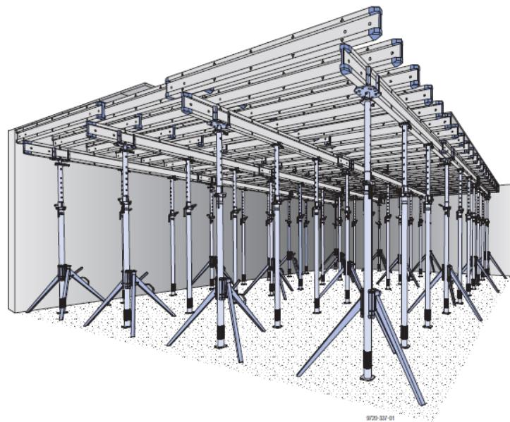
Slika 4.13. Slika 4.13. Oplati sustav Dekaflex [6]
