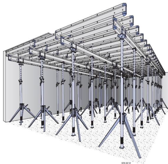
Slika 3.5. Oplati stropni sustav Dokaflex [7]
