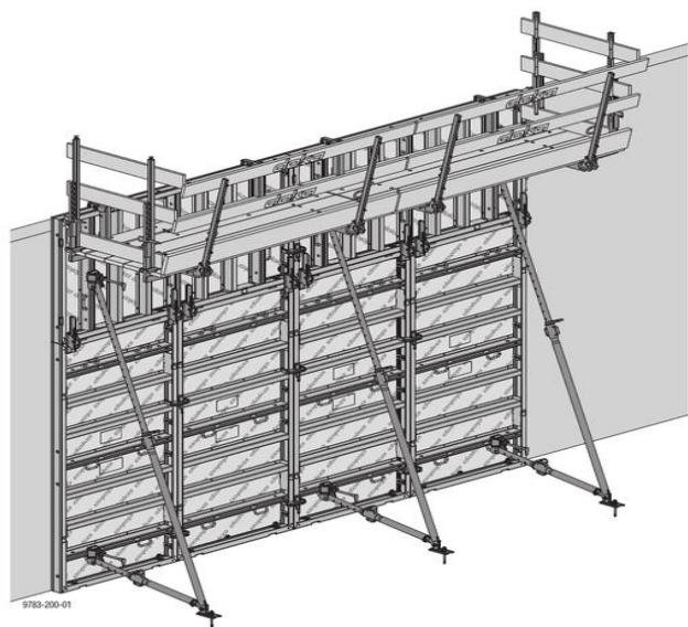
Slika 3.4. Okvirni zidni sustav Doka Framax [7]
