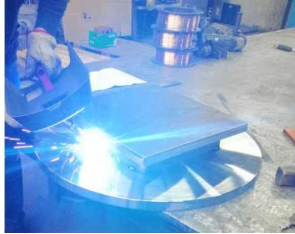
Slika 40. Bravarska montaža postolja
