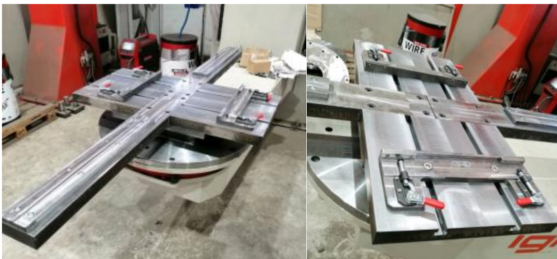
Slika 50. Naprava za robotsko zavarivanje dna transformatorskog kotla
