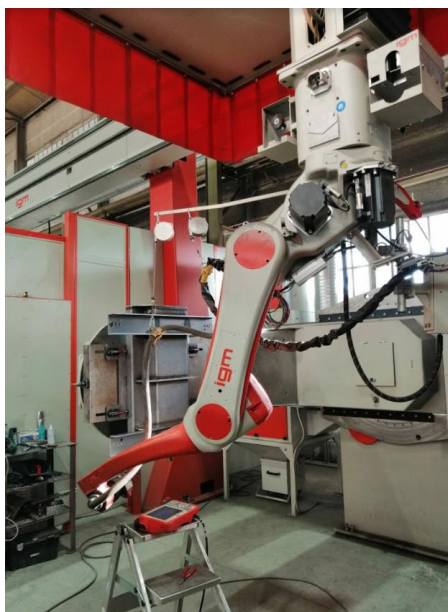
Slika 12. IGM robot RTe476SH
