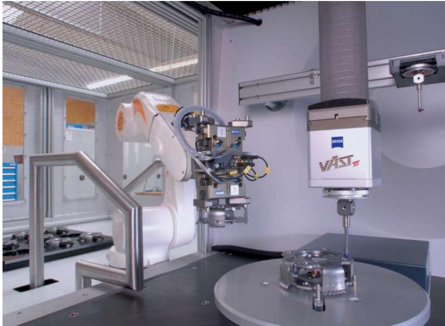
Slika 9. Robot za mjerenje i kontrolu [20]
