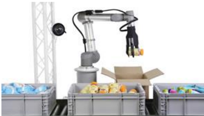
Slika 3. „Pick and place“ industrijski robot [11]
