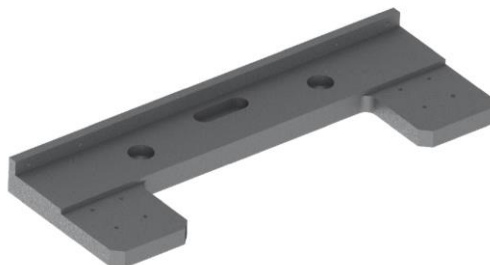
Slika 28. 3D model ploče nosača stezaljki
