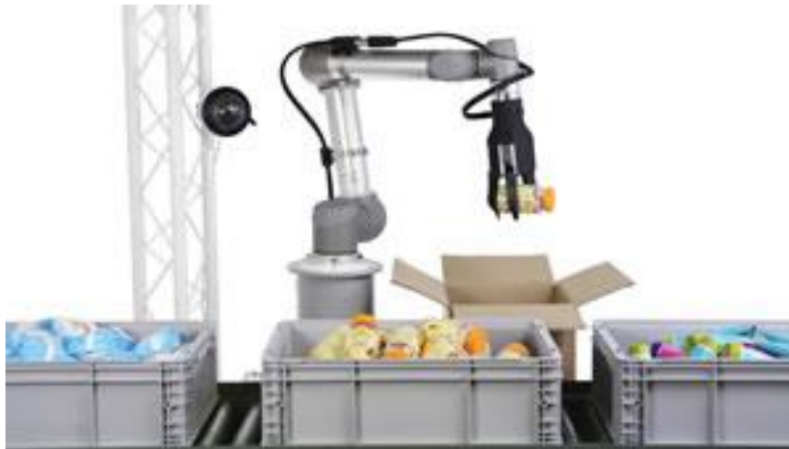
Slika 3. „Pick and place“ industrijski robot [11]
