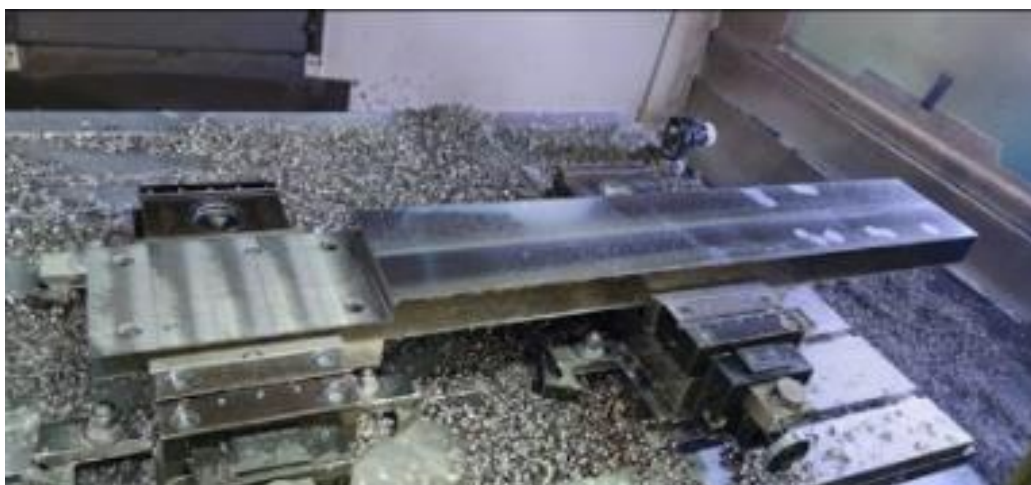
Slika 46. Ploča 1100x150x50 nakon obrade glodanjem
