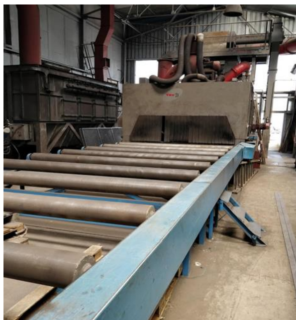
Slika 36. Protočna sačmara TST P-2500
