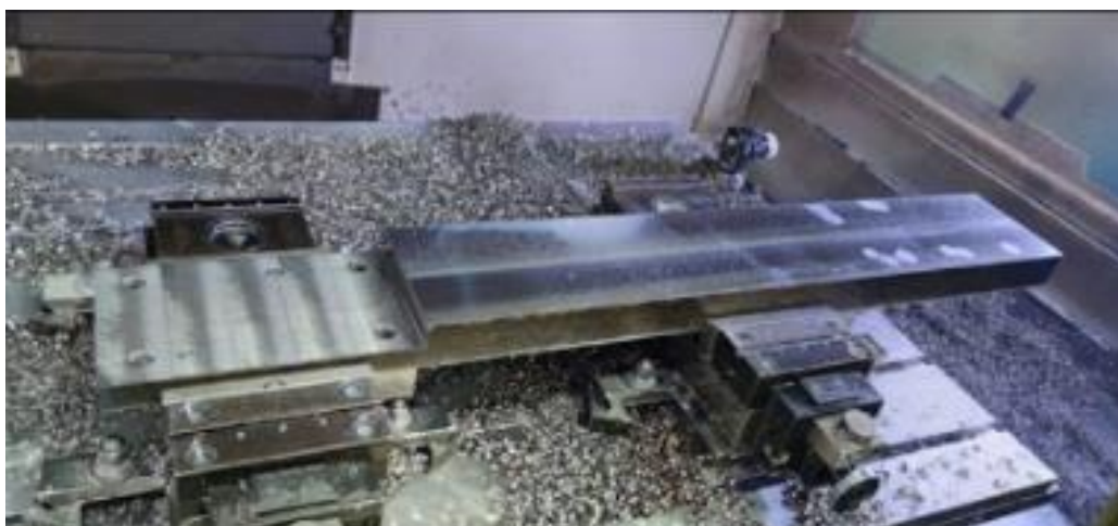
Slika 46. Ploča 1100x150x50 nakon obrade glodanjem
