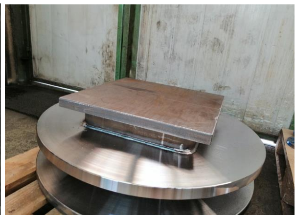
Slika 42. Postolje nakon bravarske montaže i zavarivanja
