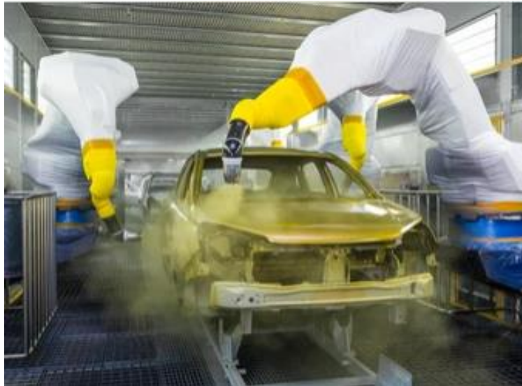
Slika 4. Primjena robota u procesu lakiranja automobila [12]
