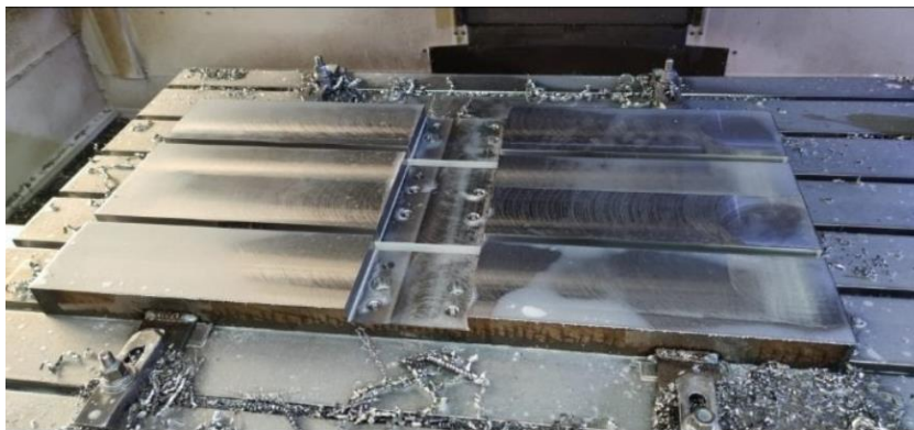
Slika 45. Ploča 1000x500x50 nakon obrade glodanjem
