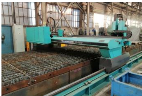
Slika 35. Stroj za rezanje plazmom SATO SATRONIK LS-3500
