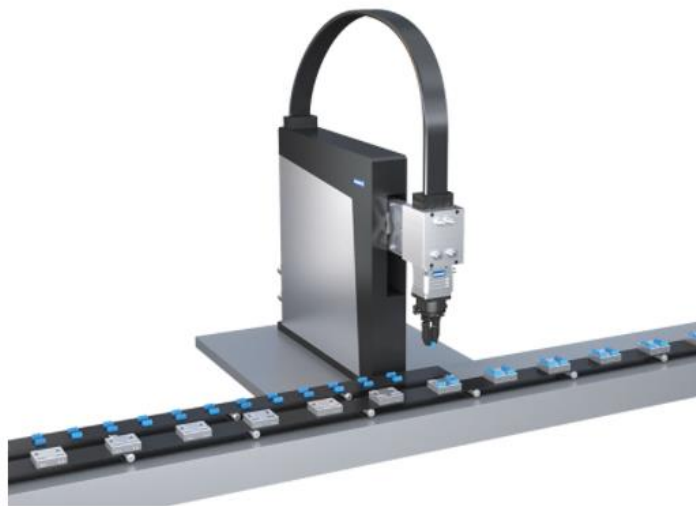
Slika 2. Transport pokretnom trakom i jednostavan manipulacijski automat [10]
