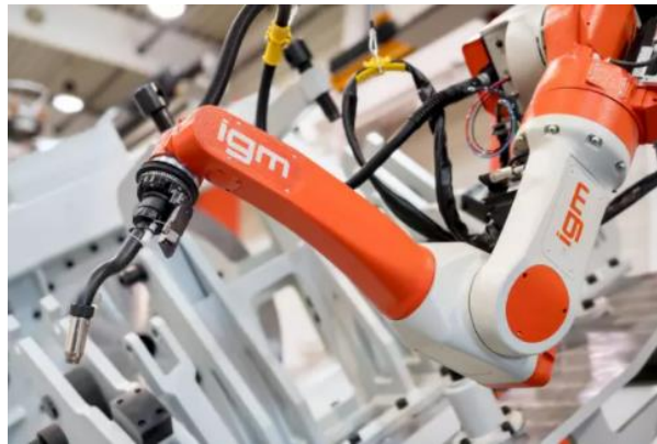
Slika 10. IGM robot za zavarivanje RTe400 [21]
