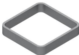
Slika 21. 3D model cijevi kv. 400x70x16
