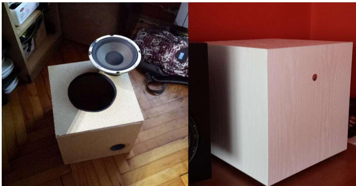
Slika 5.18 Kutija za niskotonski zvučnik
