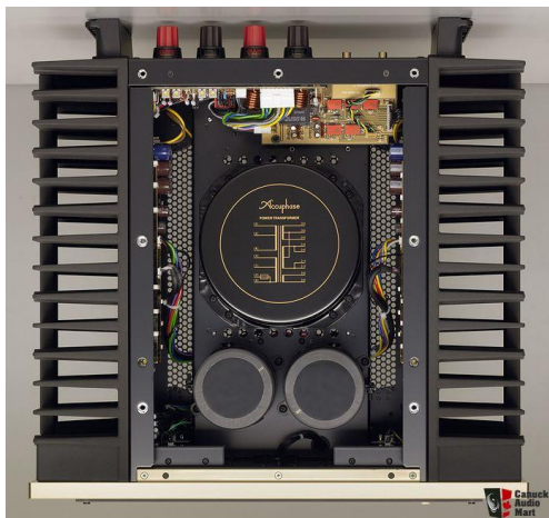
Slika 3.3 Pojačalo klase A, važno je primijetiti da napajanje i hladnjaci zauzimaju skoro cijelo kućište pojačala [17]
