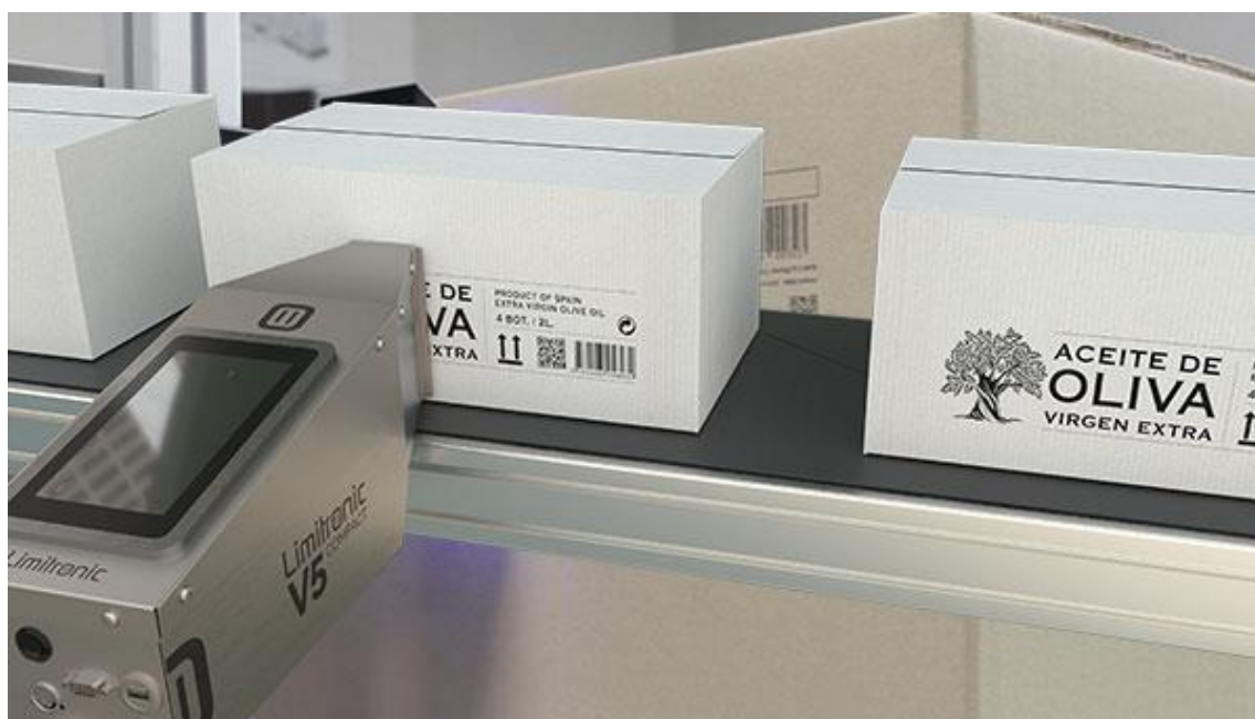
Slika 7. Ind. pisač v5 compact i primjer otiska, izvor: limitronic.com
