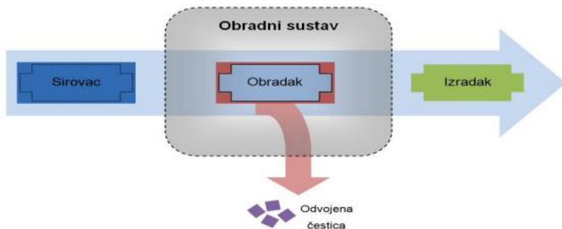
Slika 1.1 Obrada odvajanjem čestica [2]
