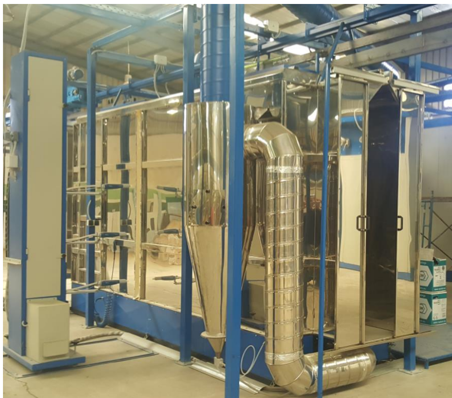
Slika 5.7. Komora za elektrostatski nanos bojila u prahu [24]
