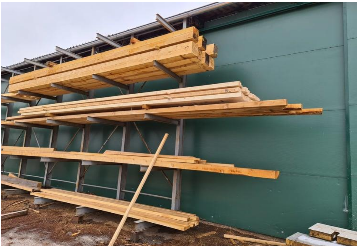
Slika 5. 22 Grede – prirodno sušenje (tretiranje)
