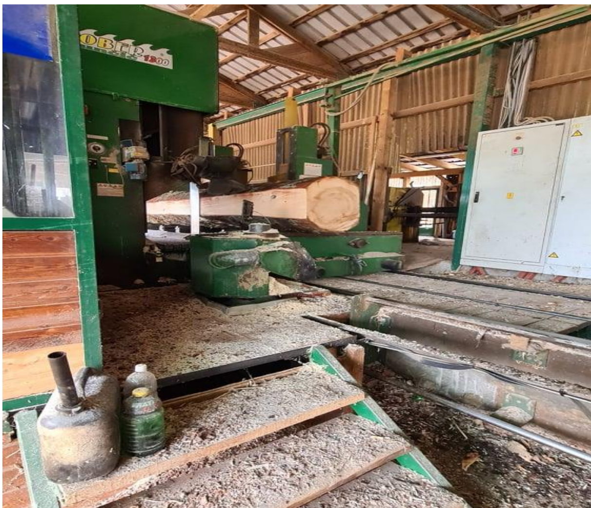
Slika 5. 14 Vertikalna tračna pila reže dijelove trupca na manje dijelove
