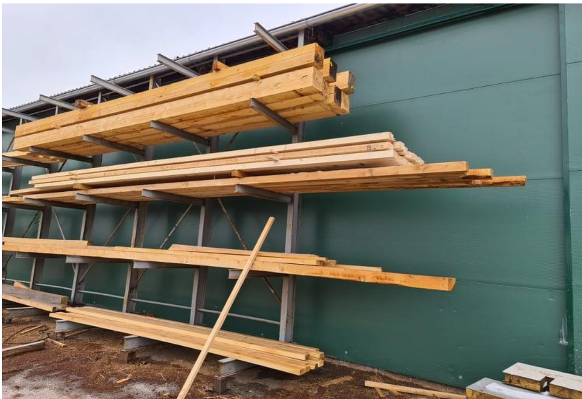
Slika 5. 22 Grede – prirodno sušenje (tretiranje)
