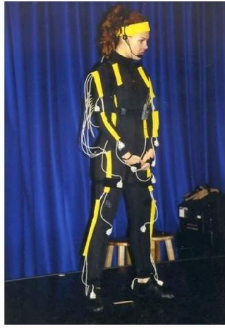
Slika 23 Oprema magnetskog sustava za hvatanje pokreta, izvor:
