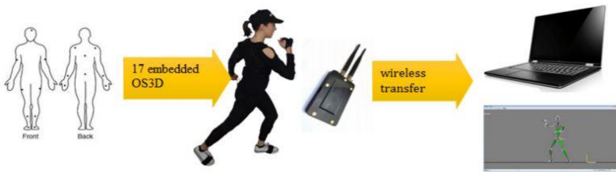
Slika 29 Struktura i sučelje sustava za snimanje pokreta [5]
