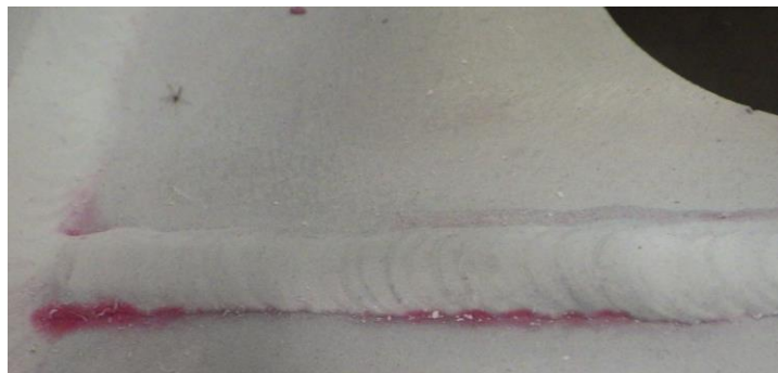
Slika 8.14 Naljepljivanje na korijenskom dijelu zavora BW 10HV/KP
