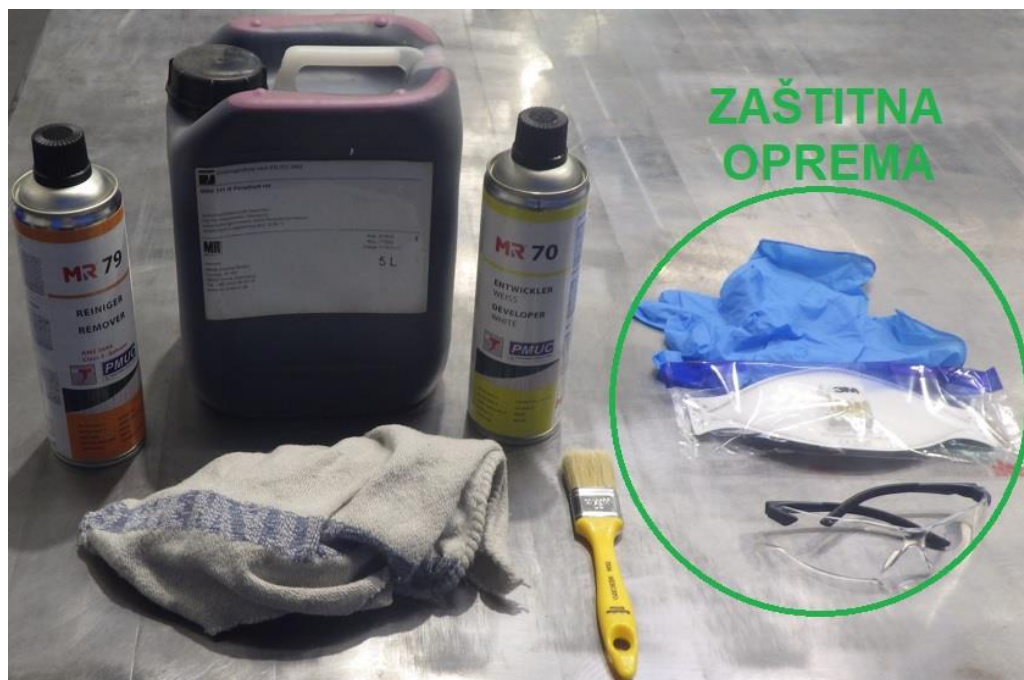
Slika 8.1 Oprema za PT ispitivanje zavara
