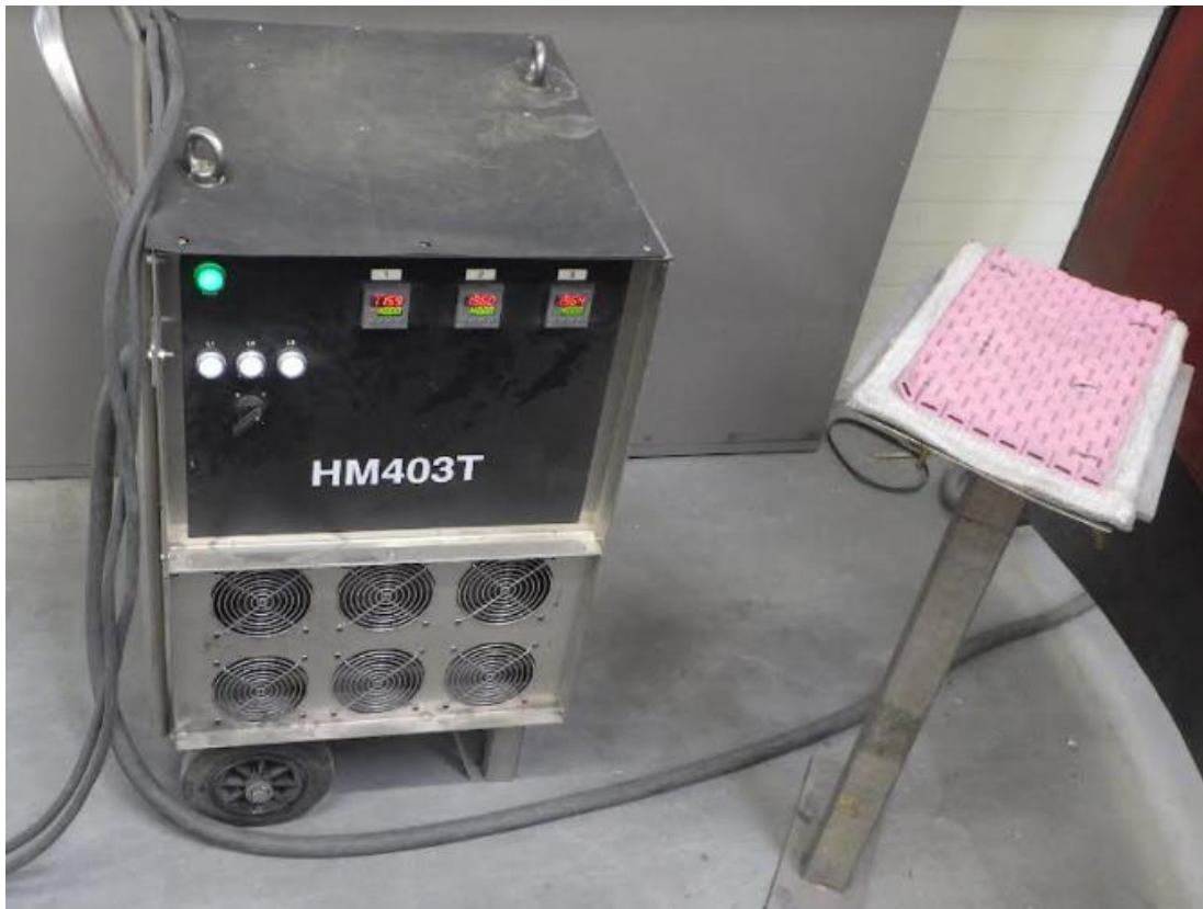
Slika 7.5 Uređaj za predgrijavanje HM403T
