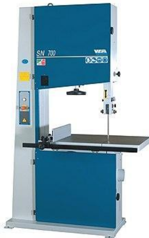
Slika 3. Okomita tračna pila [2]
