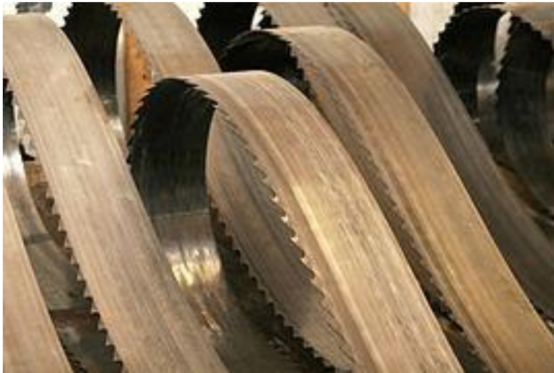
Slika 1. Listovi tračne pile [2]
