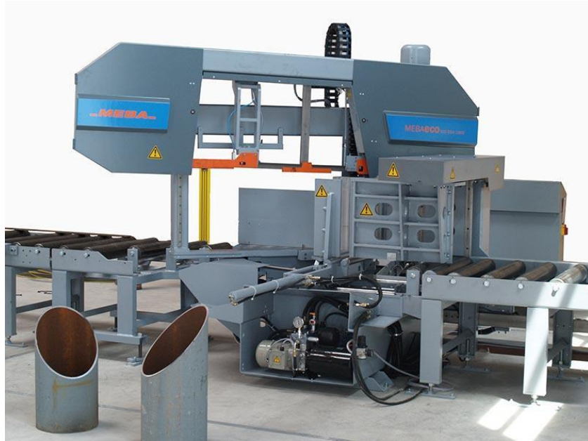
Slika 2. Vodoravna tračna pila [3]
