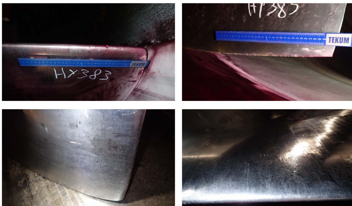
Slika 25. Površinske greške utvrđene vizualnom metodom ispitivanja
