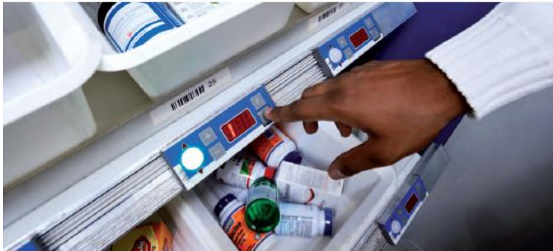
Slika 4.17 Prikaz principa rada "Pick to Light". [10]
