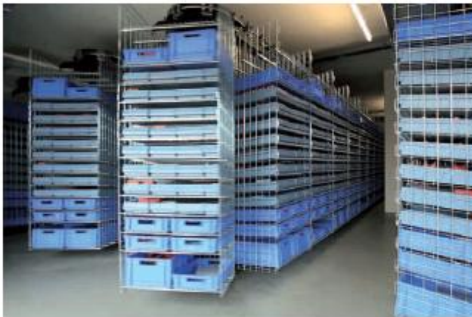
Slika 4.13 Izgled Kardex Remstar horizontalnog karusela. [10]
