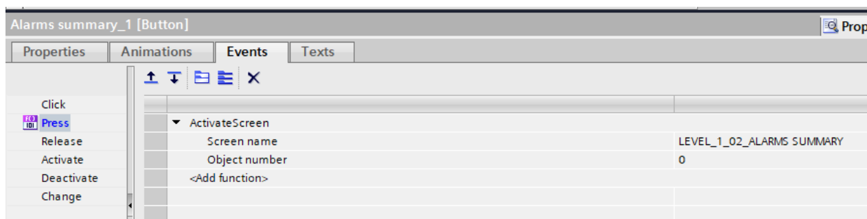
Slika 10 Primjer gumba za alarme na templateu
