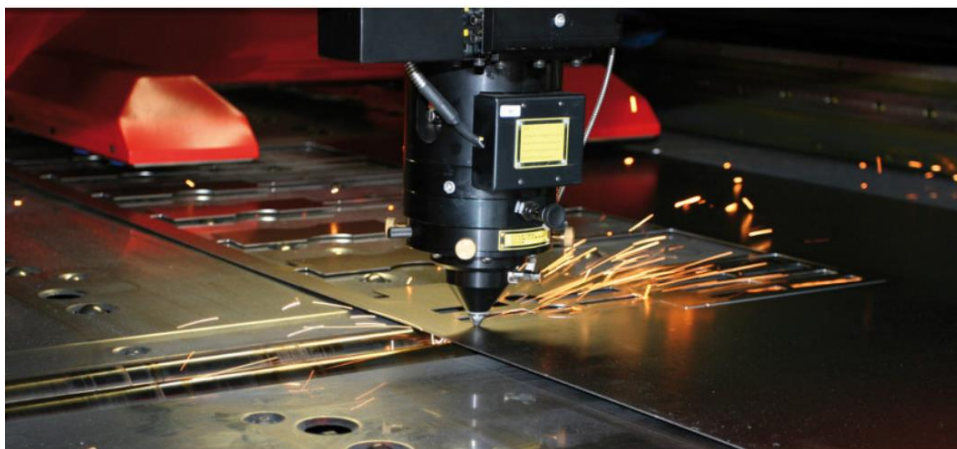
Slika 5. Lasersko rezanje lima [11]
