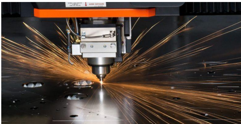
Slika 20. Lasersko rezanje lima [37]
