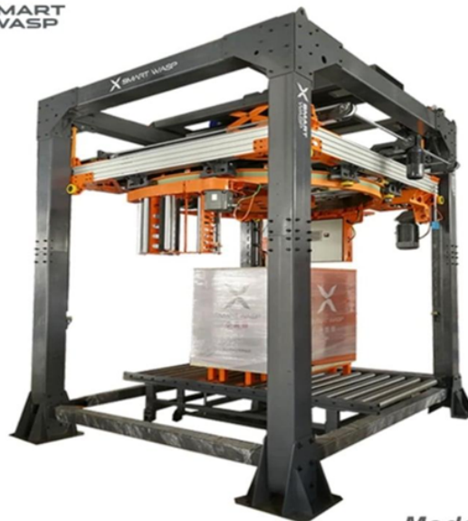
Slika 26: Prikaz Spuštanja izlazne palete kroz omatalicu
