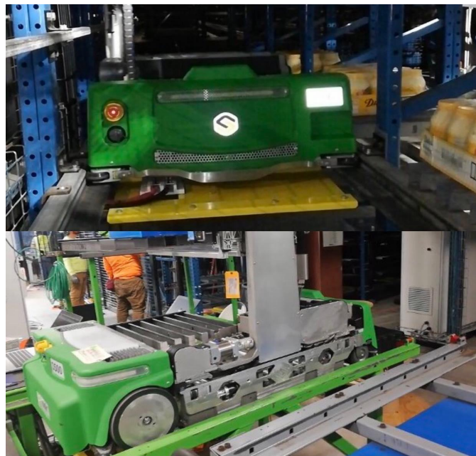
Slika 24: Prikaz shuttle-a. Gornja slika prikazuje preuzimanje robe, a istovremeno i punjenje
