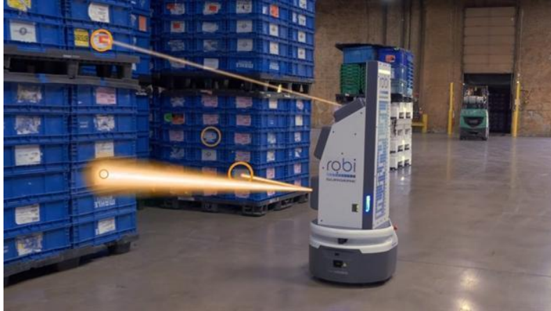
Slika 15: Prikaz autonomnog robota za inventuru [34]
