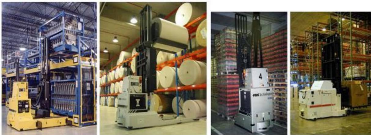
Upotreba AGV-a za skladištenje rezervnih dijelova (primjer iz autoindustrije)
