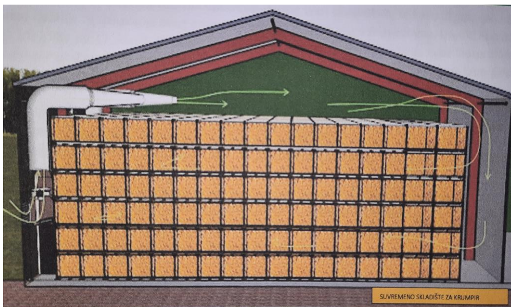
Slika 23. Skica kompaktnog paletnog skladišta
