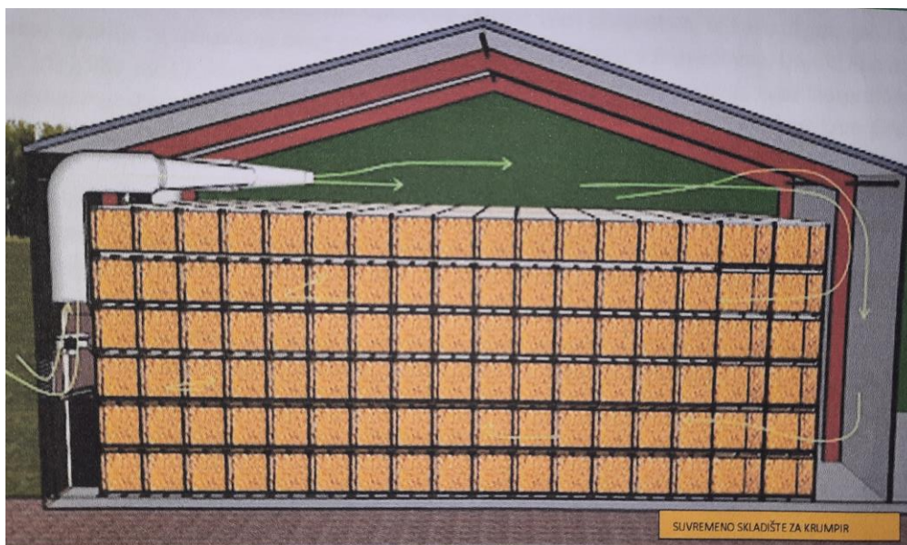
Slika 23. Skica kompaktnog paletnog skladišta
