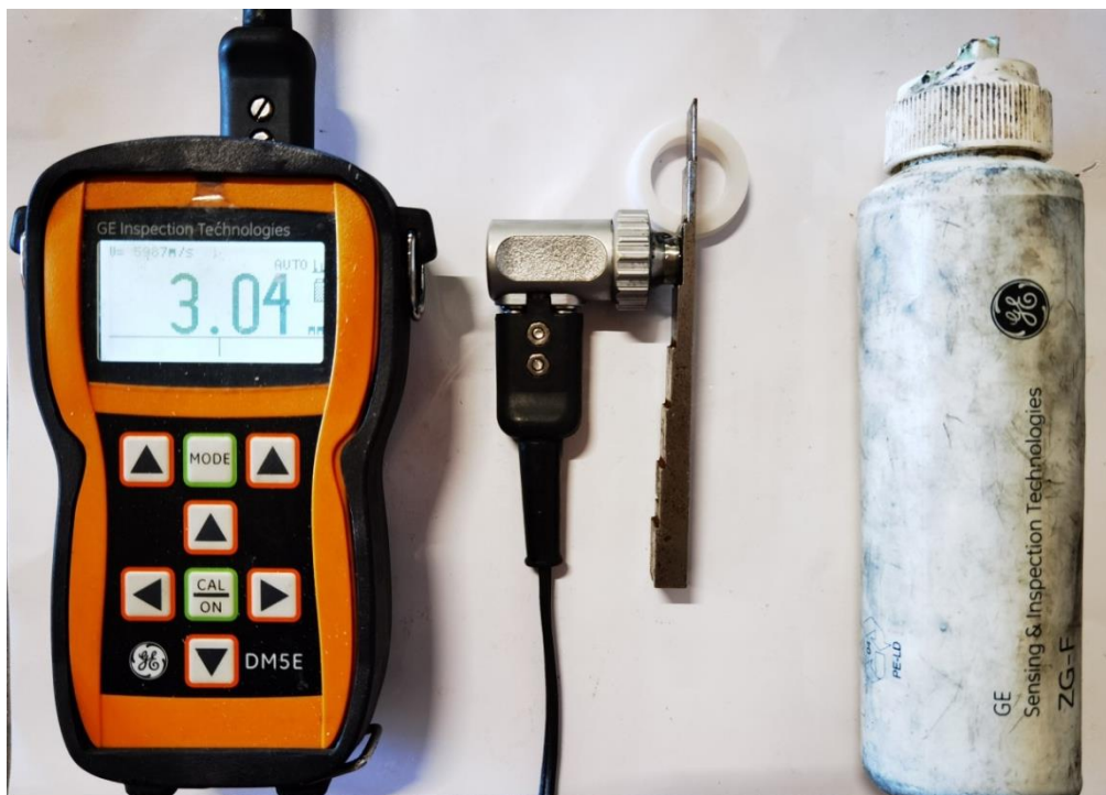
Slika 12. Instrument i oprema za ultrazvučno mjerenje debljine stjenke
