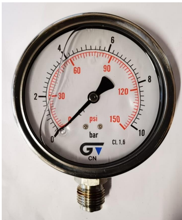
Slika 9. Kontrolna oprema – manometar
