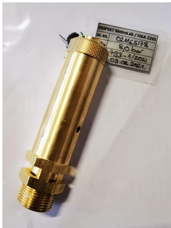
Slika 8. Sigurnosna oprema – sigurnosni ventil
