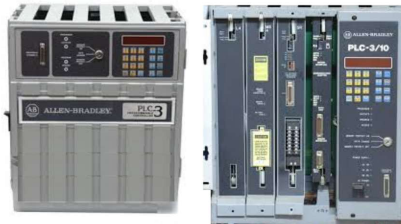
Slika 3. 1 Primjer prvog PLC-a Allen Bradley [5]
