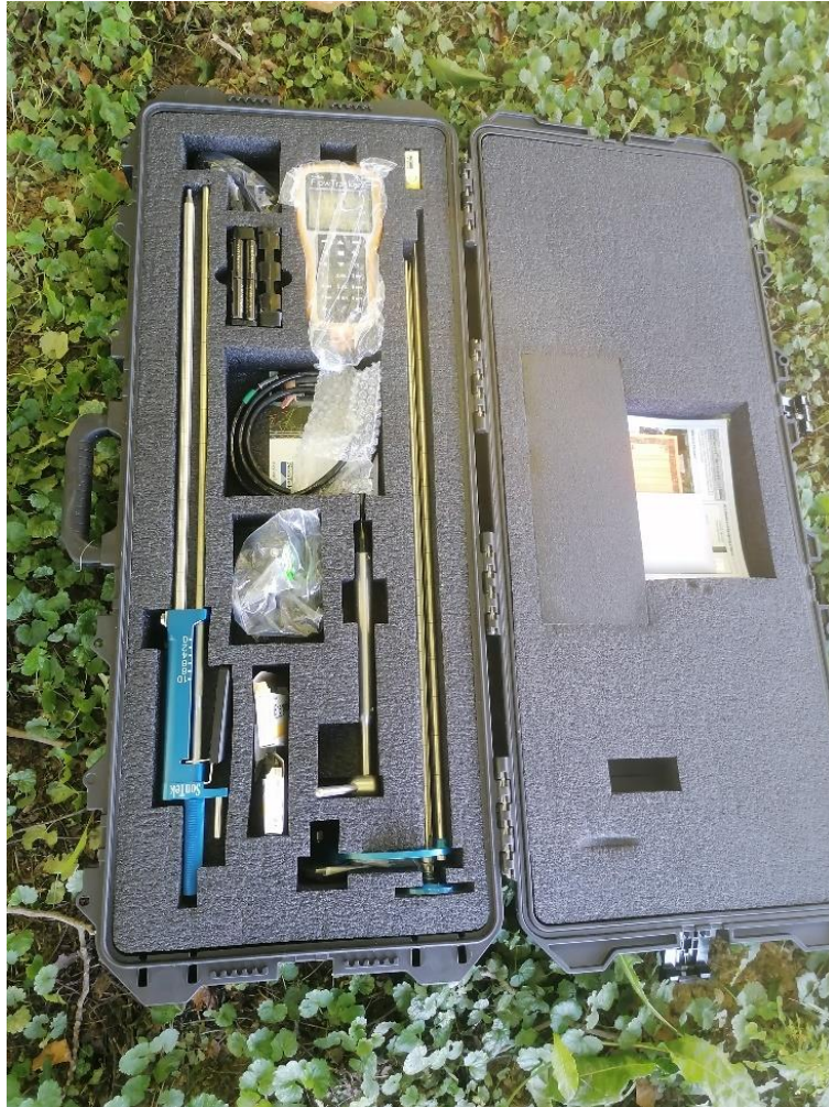
Slika 3.5. Ultrazvučni mjerač protoka Flow Tracker 2
