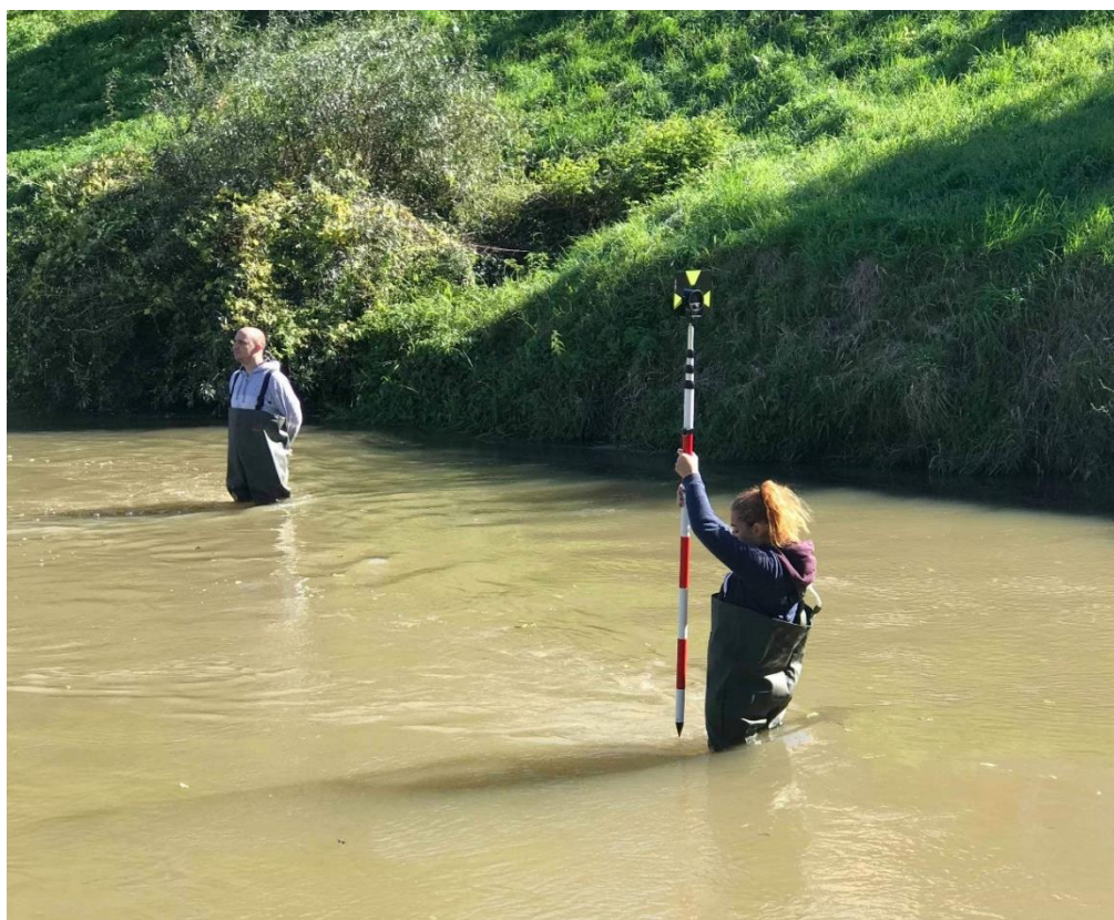
Slika 2.2. Geodetsko određivanje nagiba dna vodotoka [3]
