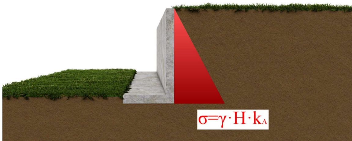
Slika 4 : Naprezanja uzrokovana aktivnim tlakom
