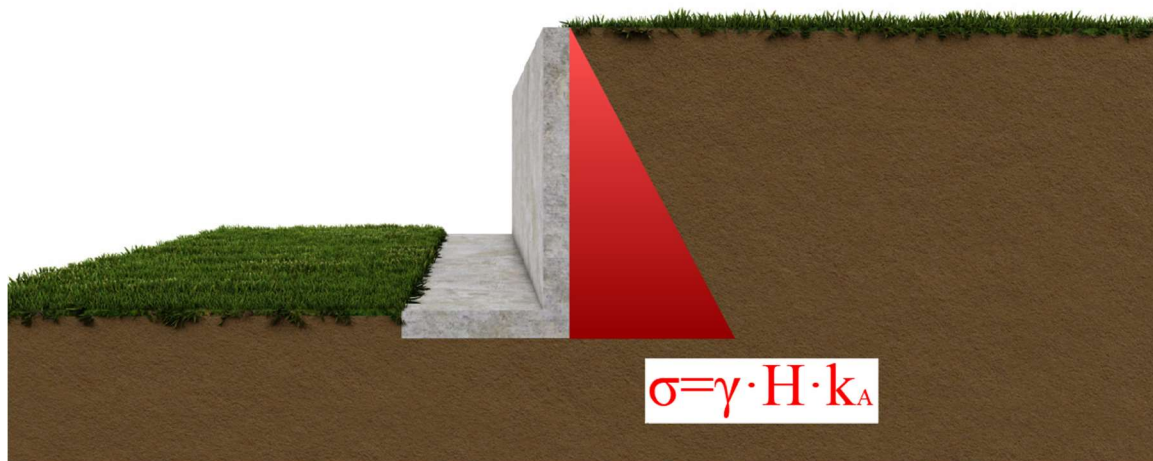
Slika 4 : Naprezanja uzrokovana aktivnim tlakom
