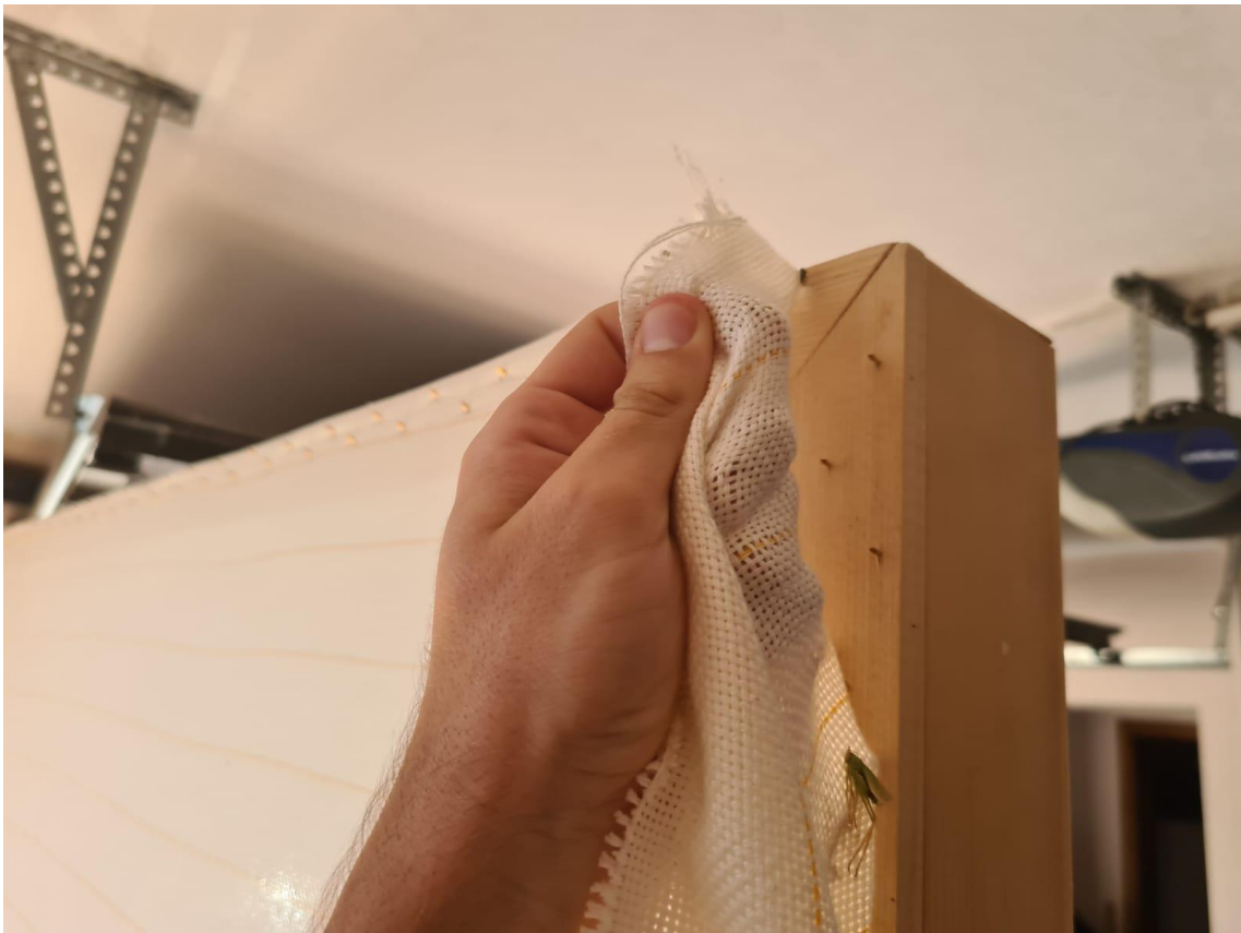
Slika 25. Vizualni prikaz stavljanja platna na okvir
