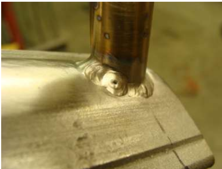
Slika 5.17 Površina zavarenog spoja gdje su vidljive tzv. "riblje oči" koje su rezultat vodika u zavaru [20]
