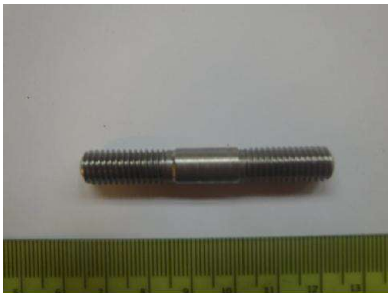
Slika 6.2 Implatni uzorak s obostranim navojem [17]
