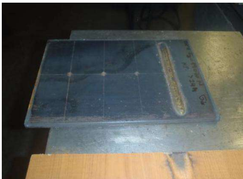
Slika 6.4 Prikaz navara na Implant ploči [17]
