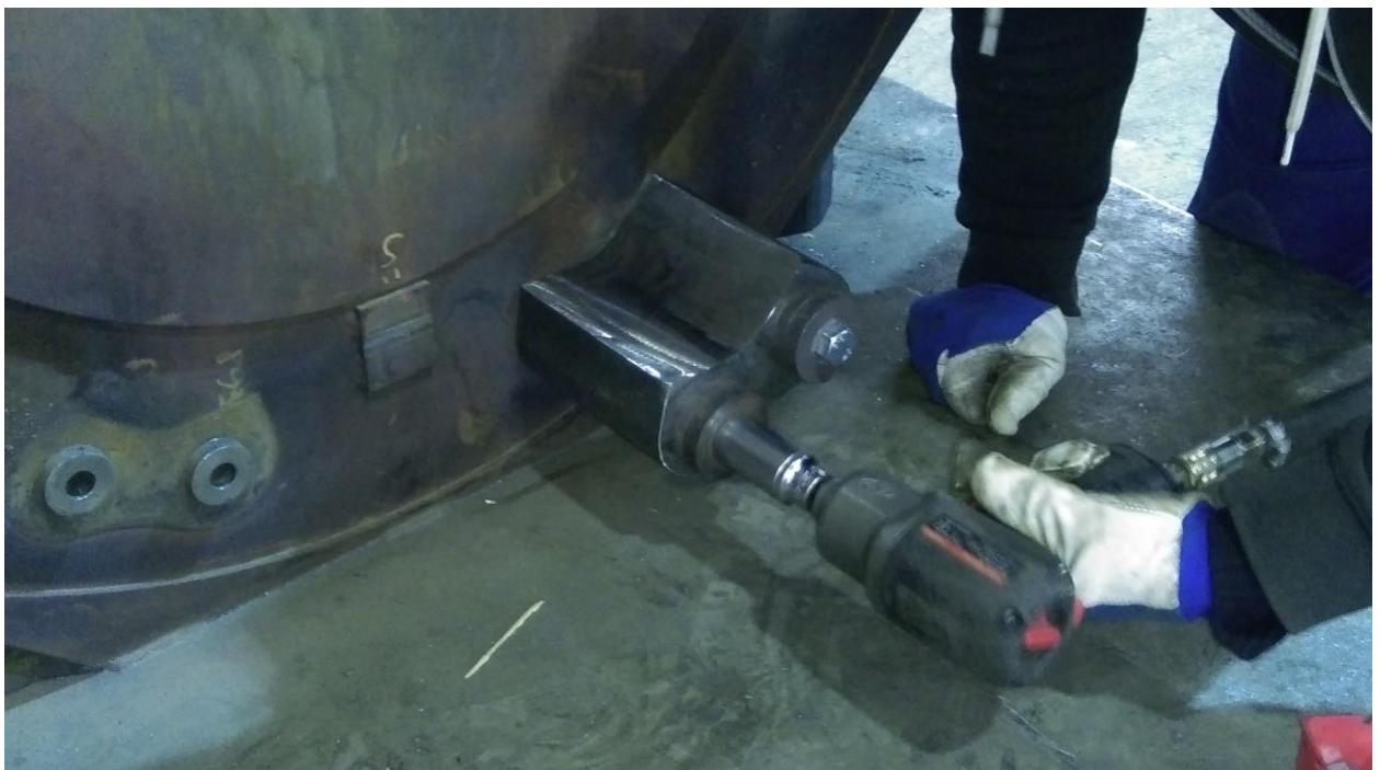
Slika 5.14 Pozicioniranje držača na vertikalnu napravu
