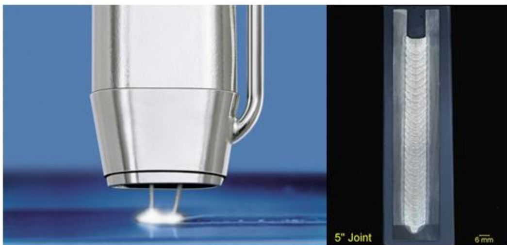
Slika 3.8 Prikaz Tandem MAG zavarivanja [14,15]
