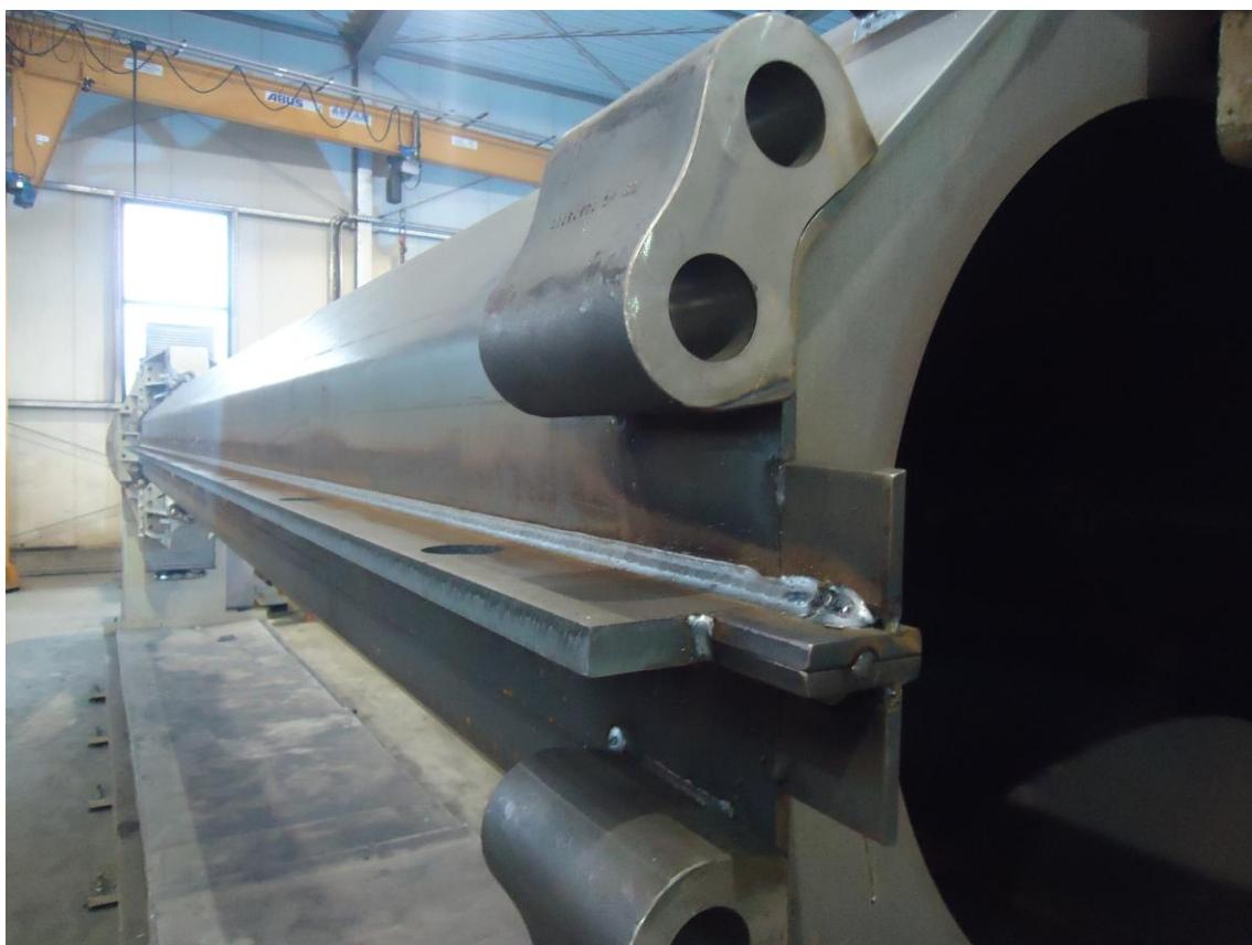
Slika 5.13 Izgled zavara između polovice cijevnog jarbola i šine
