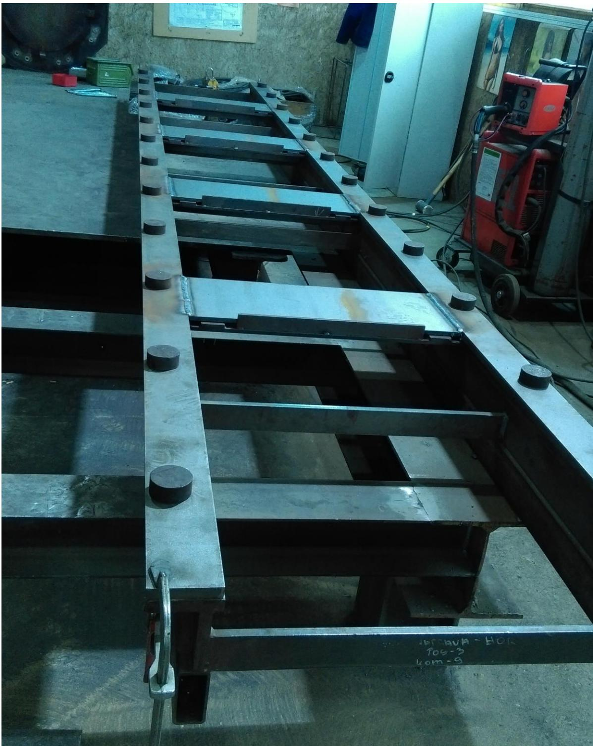
Slika 5.10 Pozicioniranje šina i poprečnih limova na horizontalnu napravu
