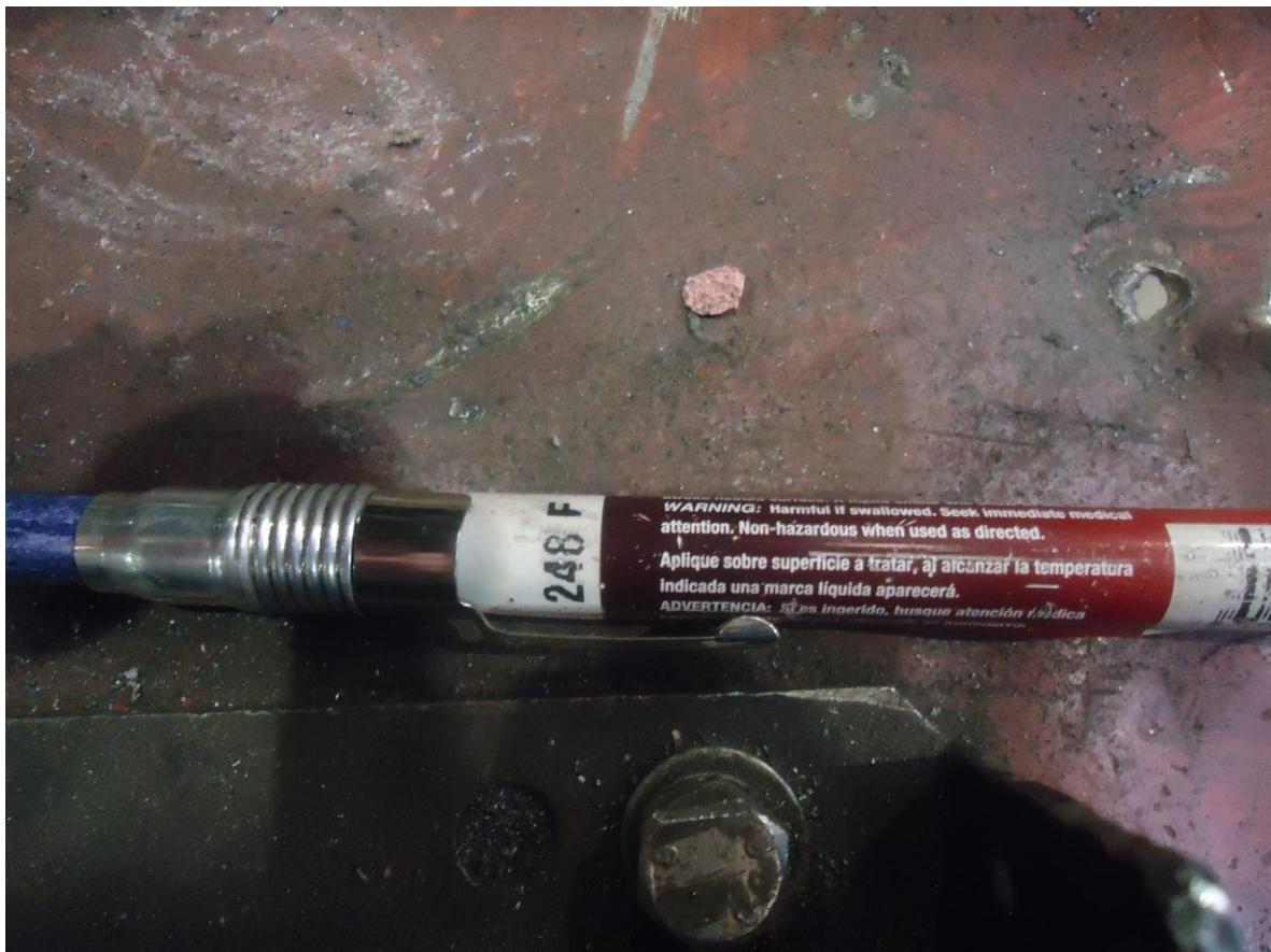
Slika 5.16 Kreda za predgrijavanje ( $120\text{ }^{\circ}\text{C}$ )
