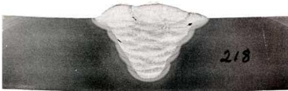
Slika 2.9 Uključak volframa u zavaru [8]
