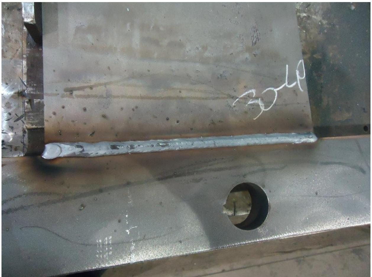
Slika 5.11 Izgled zavara (K-priprema)
