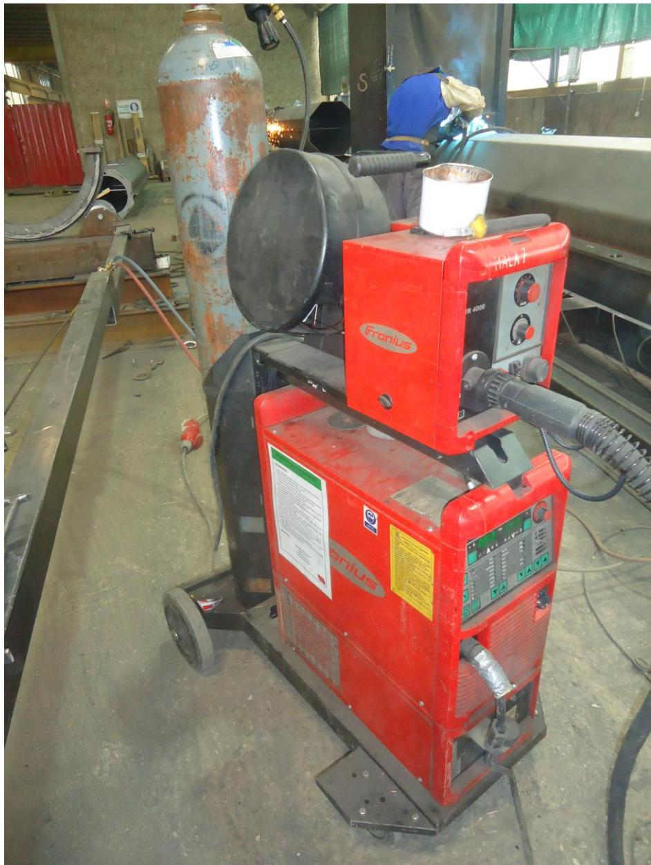
*Slika 5.7 Aparat za zavarivanje Fronius TS 5000*
