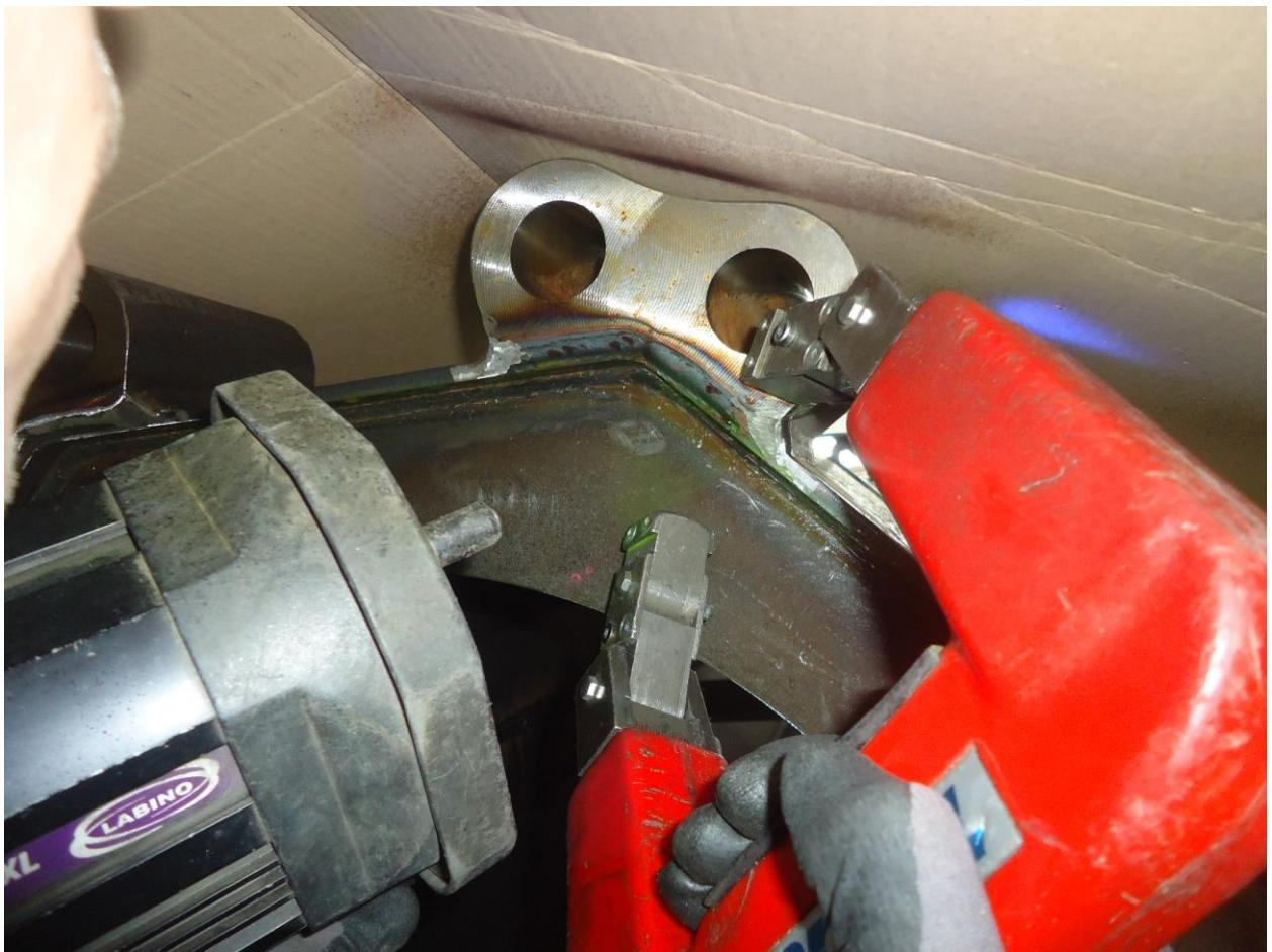
Slika 5.19 Ispitivanje magnetskom kontrolom
