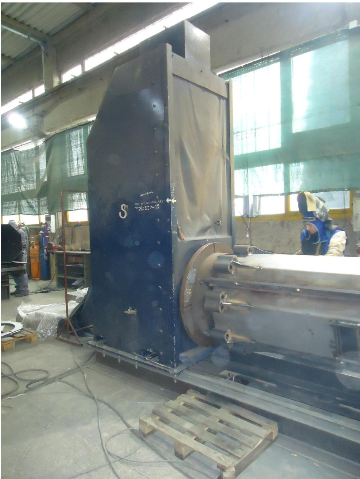
*Slika 5.17 Zavarivanje držača na pozicioneru*
