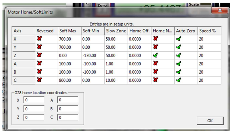
Slika 4.19 Prikaz vrijednosti za krajnje točke i soft limits
