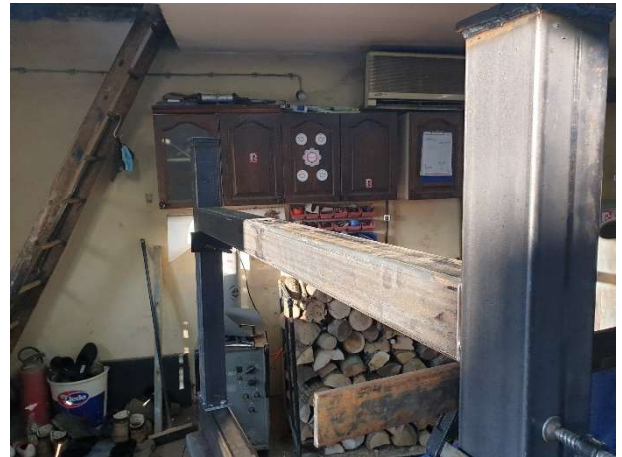
Slika 3.10 Spajanje nogu ispod Y osi
