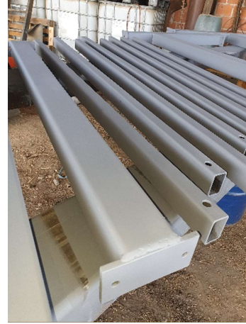
Slika 3.39 Premaz temeljnom bojom
