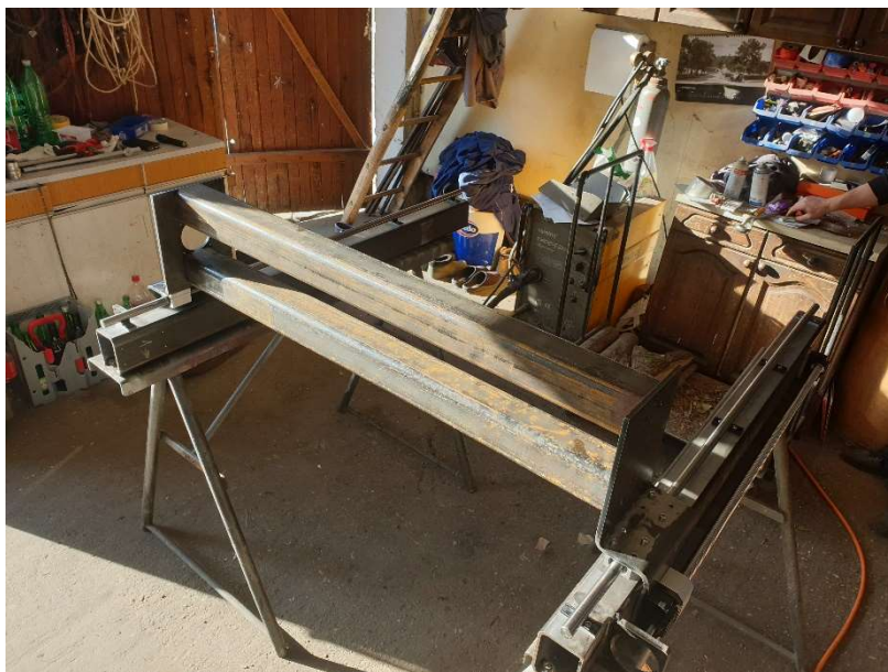
Slika 3.24 Probna montaža X osi
