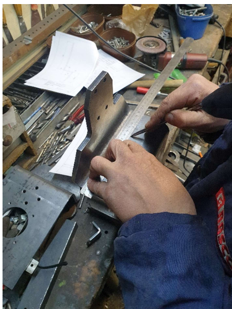
Slika 3.22 Obilježavanje pozicija za provrte
