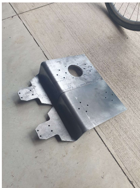
Slika 3.20 Nosac X osi
