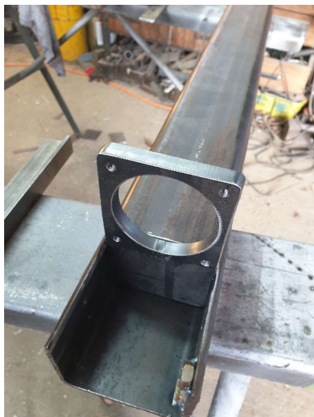
Slika 3.11 Spajanje nosača koračnog motora i Y osi
