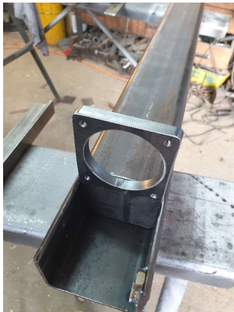
Slika 3.11 Spajanje nosača koračnog motora i Y osi
