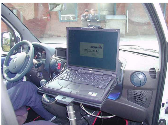
Slika 6.2 Unutrašnjost ispitnog vozila- računalo za pohranu podataka propuštanja
