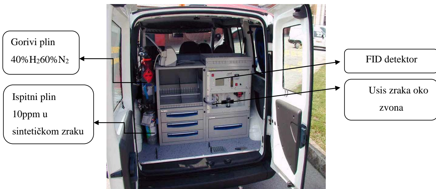
Slika 6.1 Unutrašnjost ispitnog vozila-oprema
