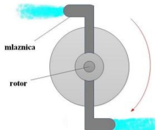
*Slika 3.8 Princip vrtnje akcijske i reakcijske turbine*
