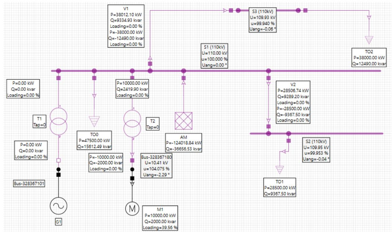
Slika 4.4 LF analiza sa uključenim motorom M1
