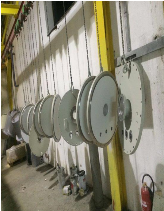
Slika 3.12 Poklopci nakon pjeskarenja
