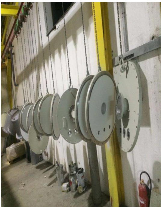
Slika 3.12 Poklopci nakon pjeskarenja
