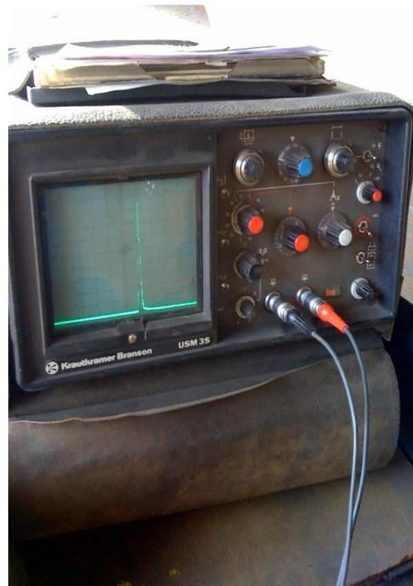
Slika 3.8 Uređaj za UZ kontrolu
