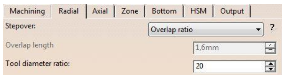
Slika 5.2.6 Preklapanje alata pri glodanju [3]
