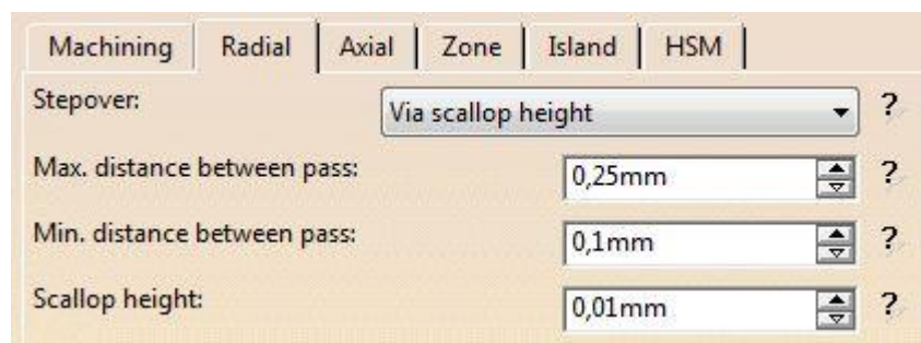
Slika 5.2.19 Preklapanje kod fine poprečne obrade [3]
