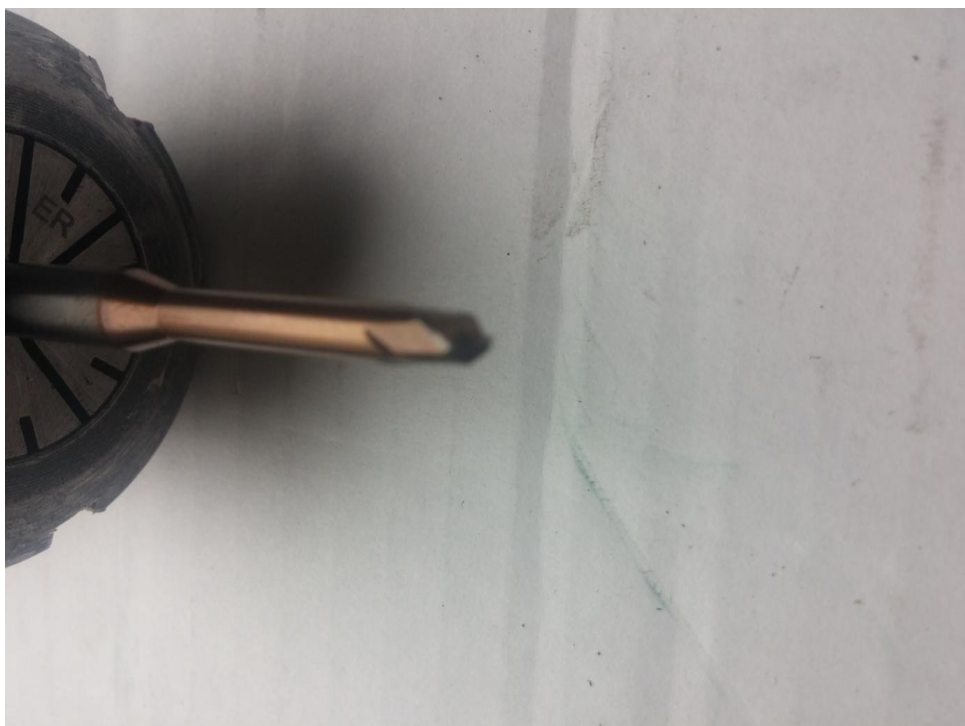
Slika 4.4.4 Glodalo za finu obradu D4 [2]
