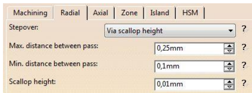
Slika 5.2.19 Preklapanje kod fine poprečne obrade [3]
