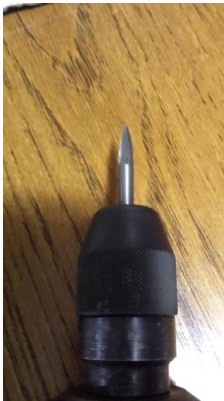
Slika 4.4.6 Glodalo za graviranje [2]
