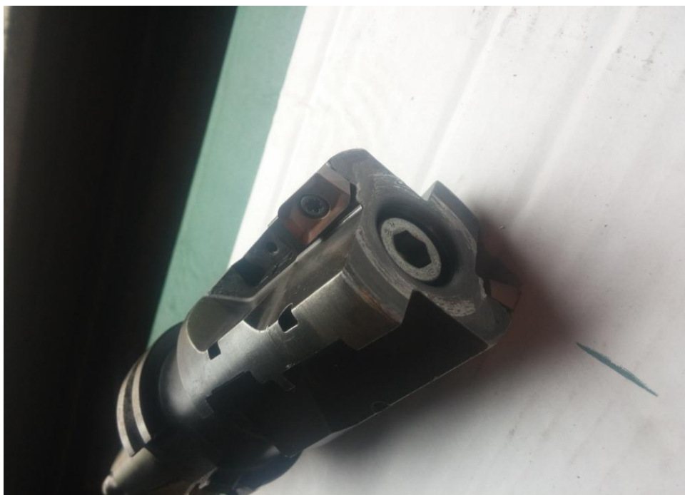
Slika 4.4.2 Glodalo D50 za poravnavanje [2]
