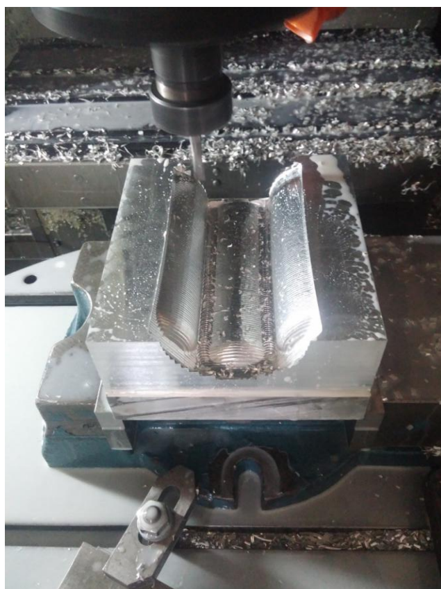
Slika 5.2.17 Grubo poprečno glodanje na stroju [2]
