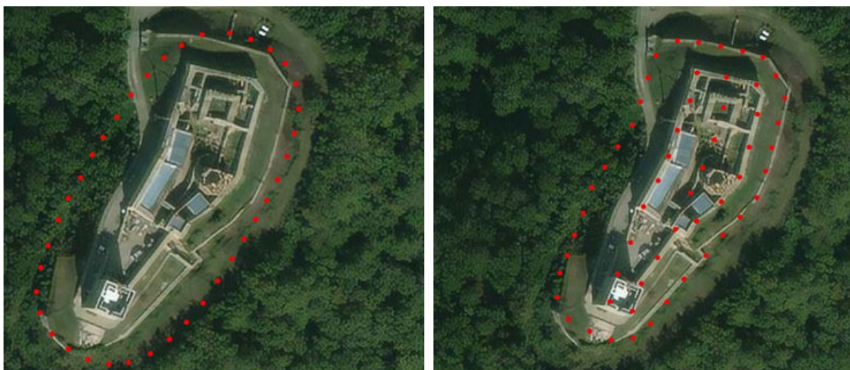
Slika 5.32 Kružni (lijevo ) i hibridni (desno) plan leta
