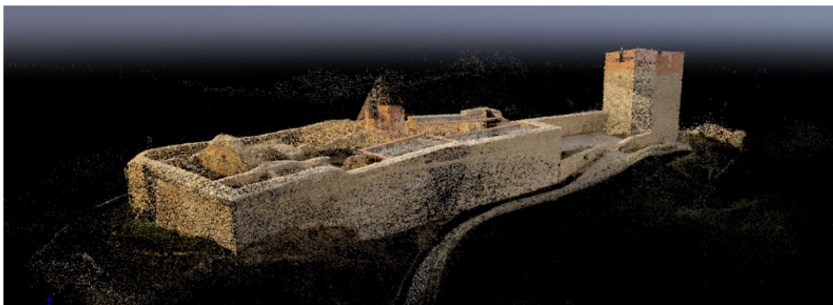
Slika 5.26 Točkasti oblak od 90% preklapanja
