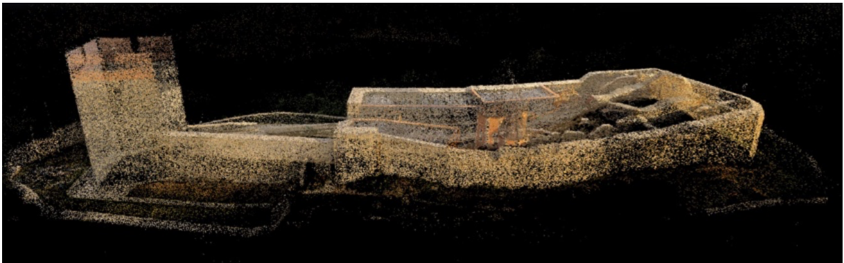
Slika 5.28 Točkasti oblak od 85% preklapanja
