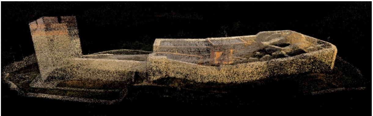
Slika 5.28 Točkasti oblak od 85% preklapanja
