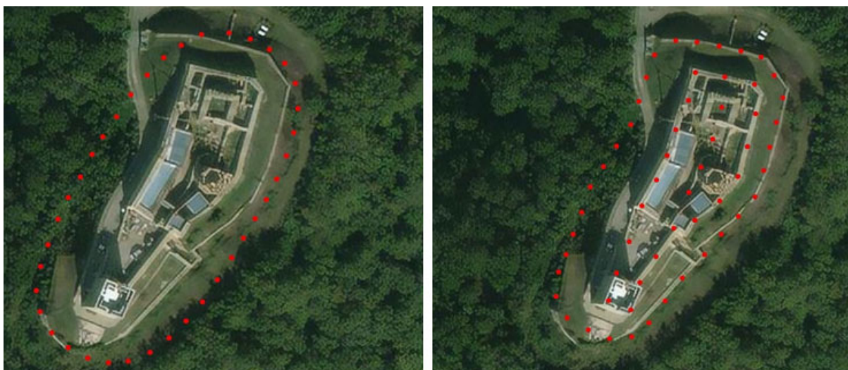
Slika 5.32 Kružni (lijevo ) i hibridni (desno) plan leta
