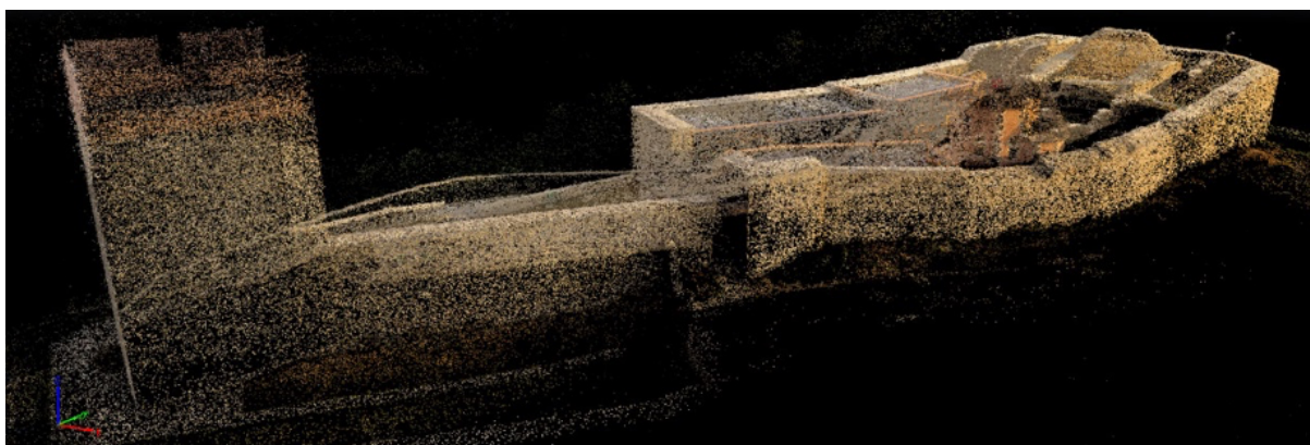
Slika 5.34 Točkasti oblak proizveden hibridnim planom leta
