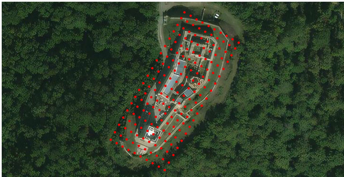
Slika 5.25 Prikaz pozicija slikanja za 90% preklapanje
