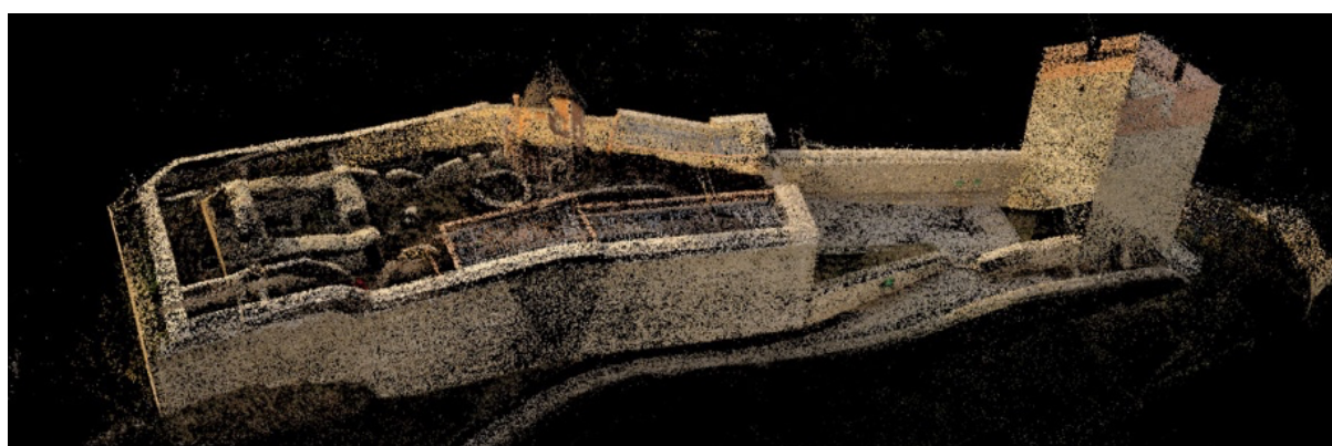
Slika 5.33 Točkasti oblak proizveden kružnim planom leta
